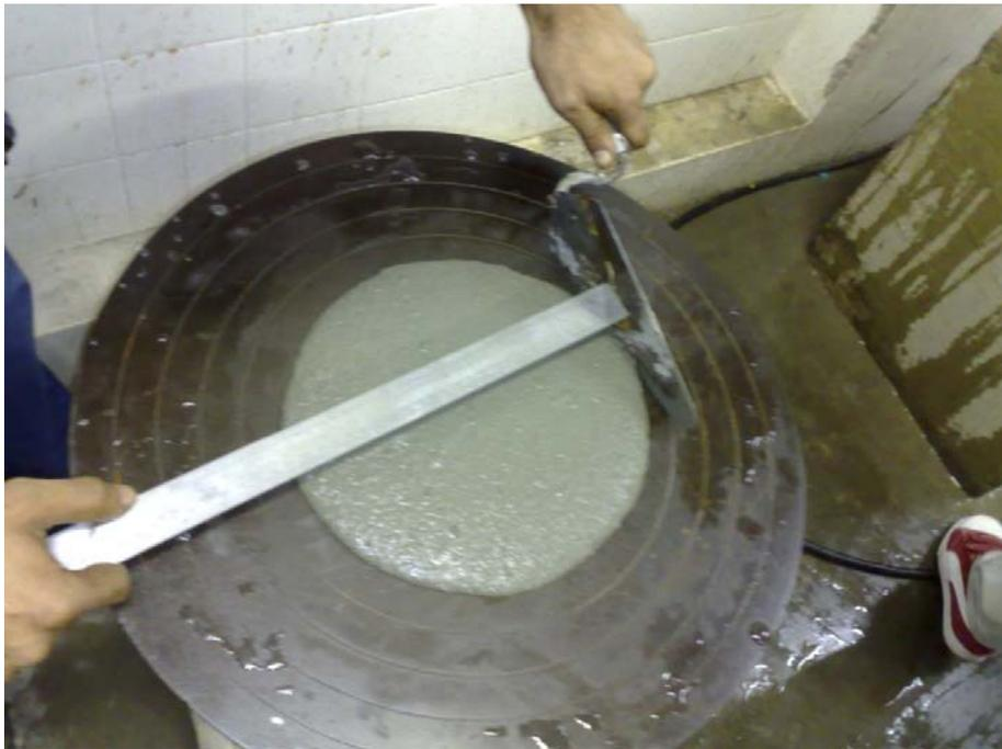
Figura 11 – Medida retirada na mesa de consistência
