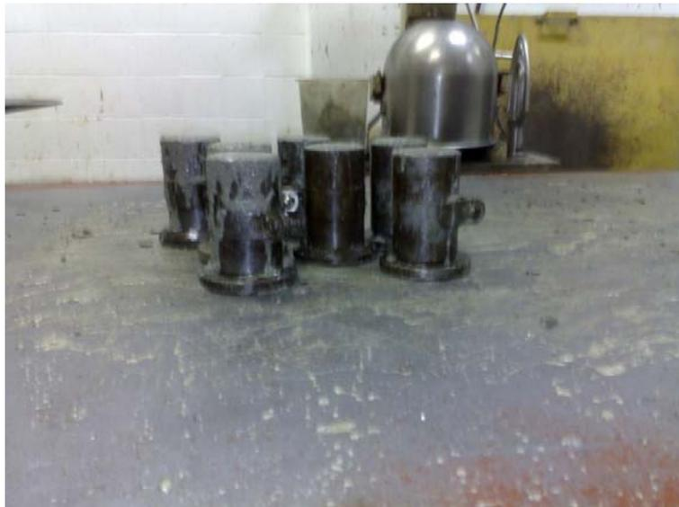
Figura 12 – Moldes cilíndricos das argamassas
