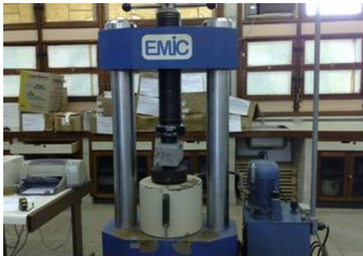
Figura 16 - Ensaio à compressão axial nas PCPs
