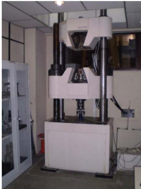
Figura 14 – Ensaio à compressão axial nos CPs das argamassas
