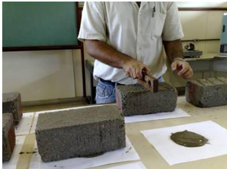
Figura 15 – Capeamento com cimento nas PCPs
