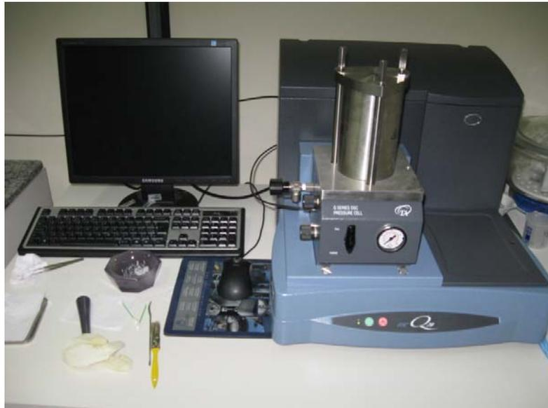
Figura 4 – Equipamento DSC Q20
