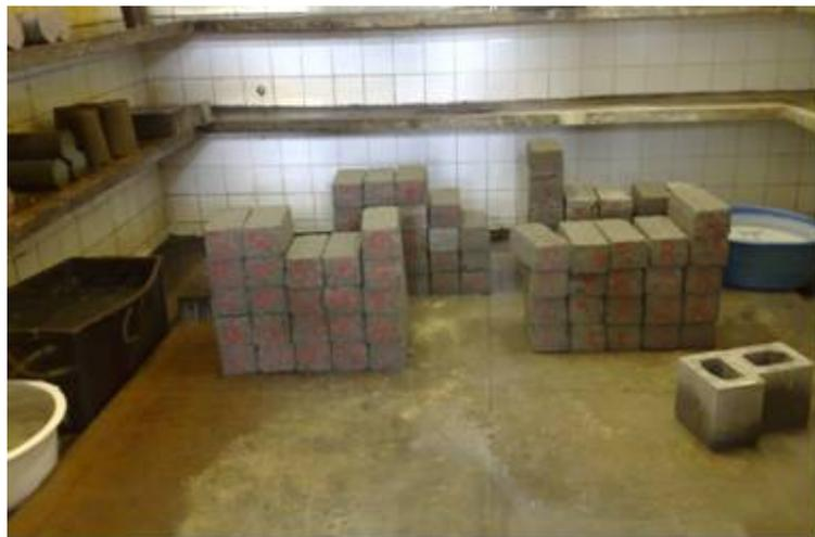
Figura 13 – Moldagem e cura das PCPs
