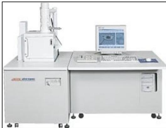
Figura 20 - Microscópio eletrônico de varredura, JEOL JSM-646
