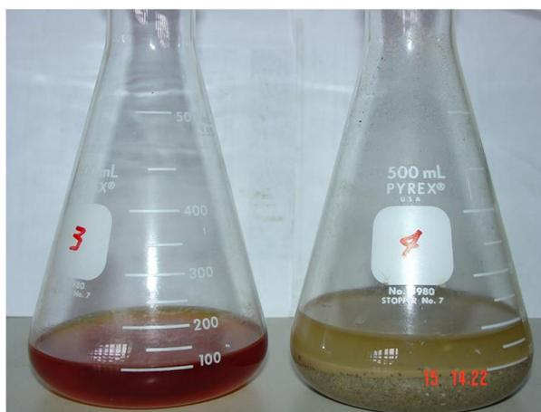
Figura 51 – Solução padrão (à esquerda) e solução com a amostra de areia avaliada (à direita).
