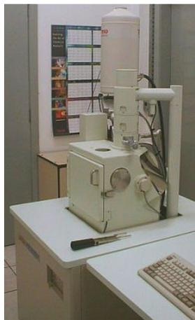
Figura 30 – Aparelho MEV JSM – 6460LV (Fonte: <http://fap01.if.usp.br/~lff/mev.html>)
