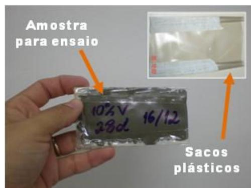
Figura 39 – Amostras retiradas durante a mistura das pastas para ensaios de análise térmica.
