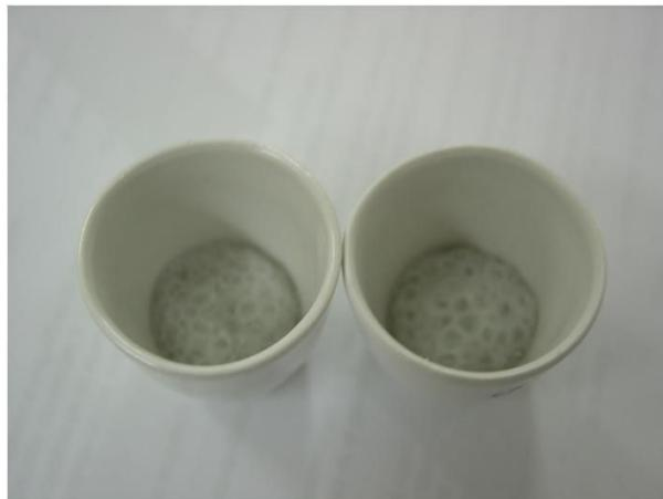
Figura 33– Amostras do RVM, após o ensaio de perda ao fogo.
