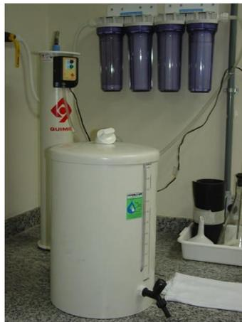
Figura 12 – Deionizador de água do Labest (COPPE/UFRJ).
