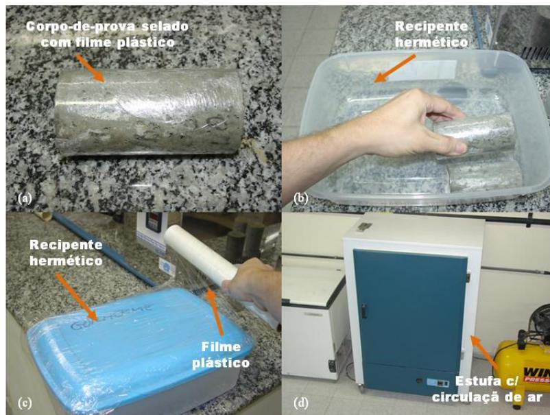
Figura 27 – Ensaio de índice de atividade pozolânica: (a) corpo de prova com filme plástico, após o desmolde; (b) e (c) acondicionamento em recipiente hermético, envolvido com filme plástico para melhor selagem e; (d) estufa com circulação de ar utilizada.
