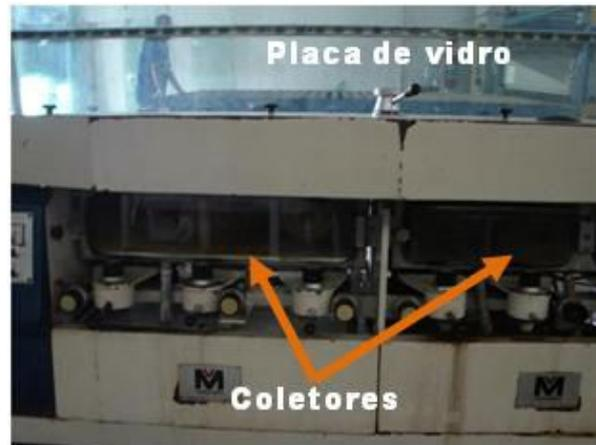
Figura 15 – Máquina específica de desbaste e regularização de placas de vidro.
