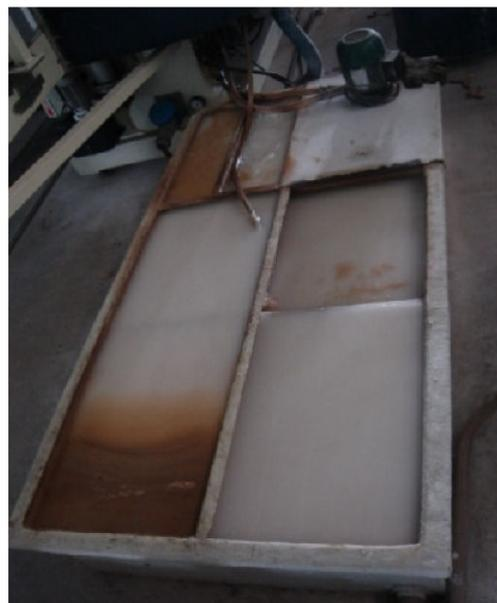
Figura 16 – Câmara de sedimentação do pó de vidro.
