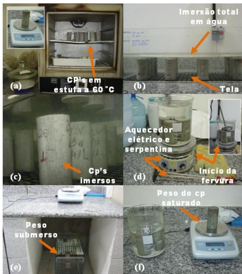
Figura 48 – Ensaio de absorção por imersão total: (a) corpos-de-prova em estufa de 60 °C para constância de massa; (b) imersão total por 72 h; (c) detalhe dos corpos-de-prova imersos; (d) corpos-de-prova levados à ebulição após 72 h imersos; (e) pesagem dos corpos-de-prova imersos após fervura e; (f) pesagem dos corpos-de-prova saturados com superfície seca.
