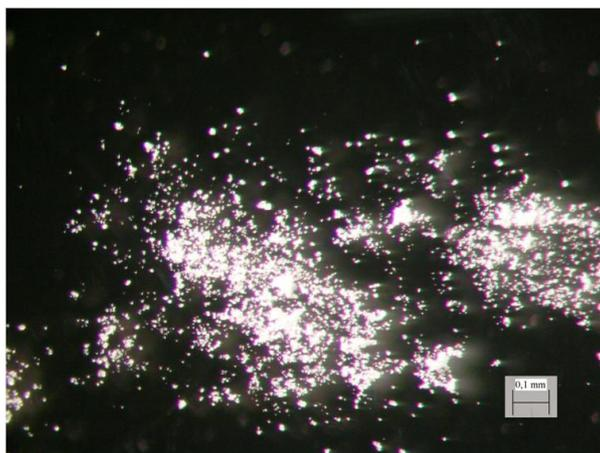
Figura 59 – Microscopia ótica do resíduo de vidro com 10x de aumento.
