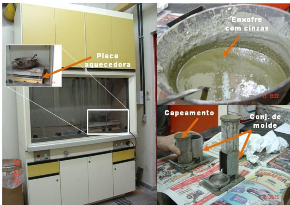
Figura 46 – Regularização de argamassas para ensaio de resistência à compressão: (a) capela com chapa aquecedora para derreter o enxofre; (b) detalhe da mistura de enxofre e cinzas e; (b) capeamento dos corpos-de-prova.
