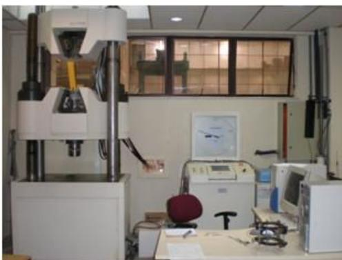
Figura 40 – Prensa servo-hidráulica Shimadzu UH-F1000 kNI.
