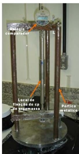
Figura 50 – Procedimento de leitura da expansão das barras de argamassa.
