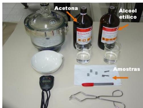
Figura 43 – Materiais utilizados para cessar a hidratação das amostras dos cubos de pasta produzidos.
