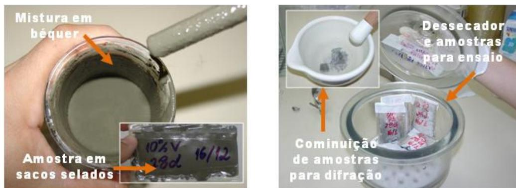
Figura 38 – Confeção das pastas para análise de difração: (a) mistura e coleta das pastas e; (b) amostras curadas no dessecador e prontas para preparação do ensaio.
