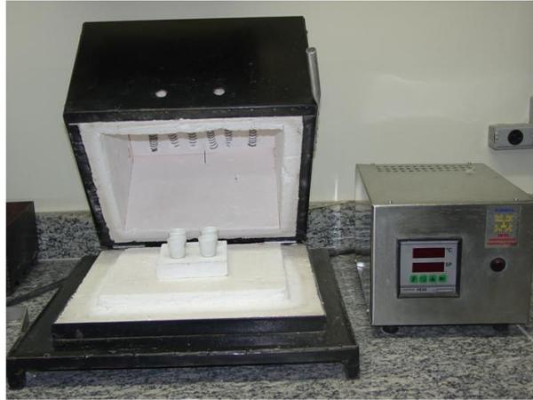
Figura 32 – Forno mufla utilizado no ensaio de perda ao fogo.
