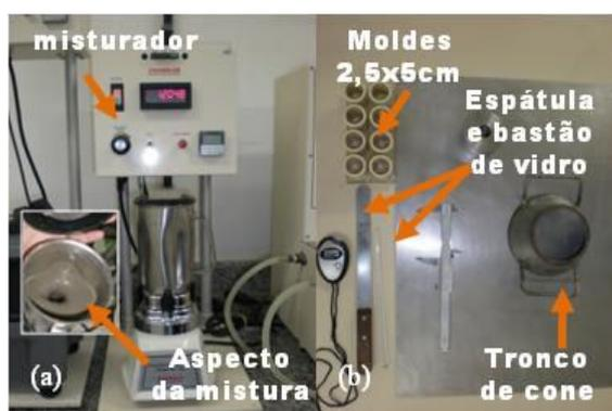
Figura 36 – Equipamentos: (a) misturador de palhetas Chandler e; (b) materiais utilizados para confecção de pastas.
