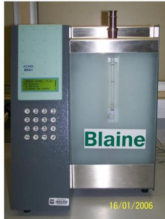
Figura 28 – Aparelho permeômetro de Blaine
