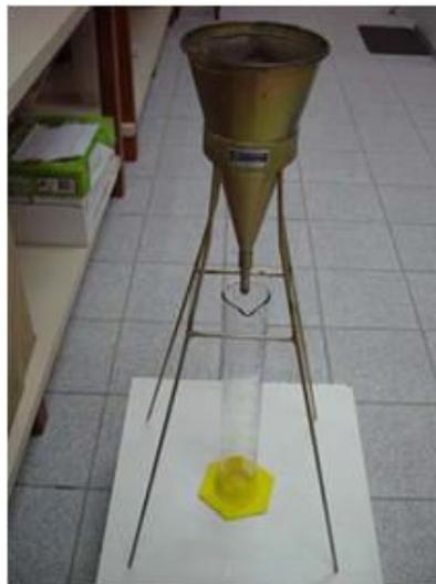
Figura 35 – Ensaio de compatibilidade e teor de saturação pelo cone Marsh.
