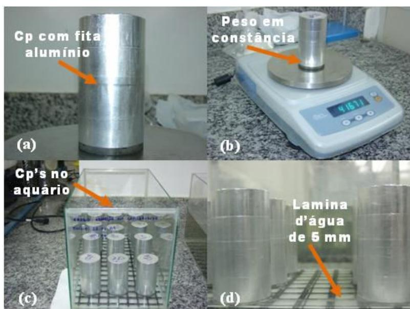
Figura 49 – Ensaio de capilaridade: (a) corpo-de-prova selado com fita de alumínio; (b) obtenção da massa do conjunto seco; (c) disposição dos corpos-de-prova no aquário e; (d) detalhe dos corpos-de-prova e lâmina d'água.
