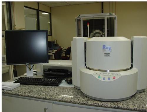
Figura 23 – Espectrômetro de fluorescência de raios x – EDX 720.
