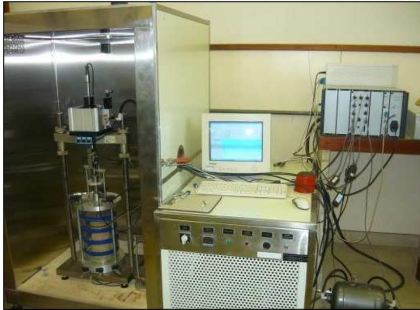
Figura 4.8 – Equipamento do ensaio triaxial dinâmico (Grupo GEOTEC)
