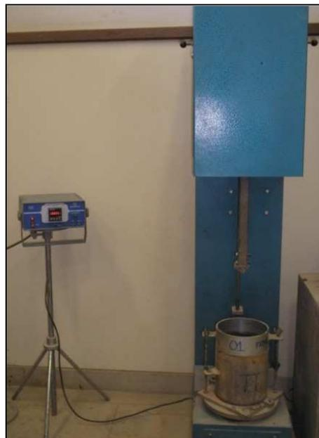
Figura 4.4 – Compactador Proctor automático
