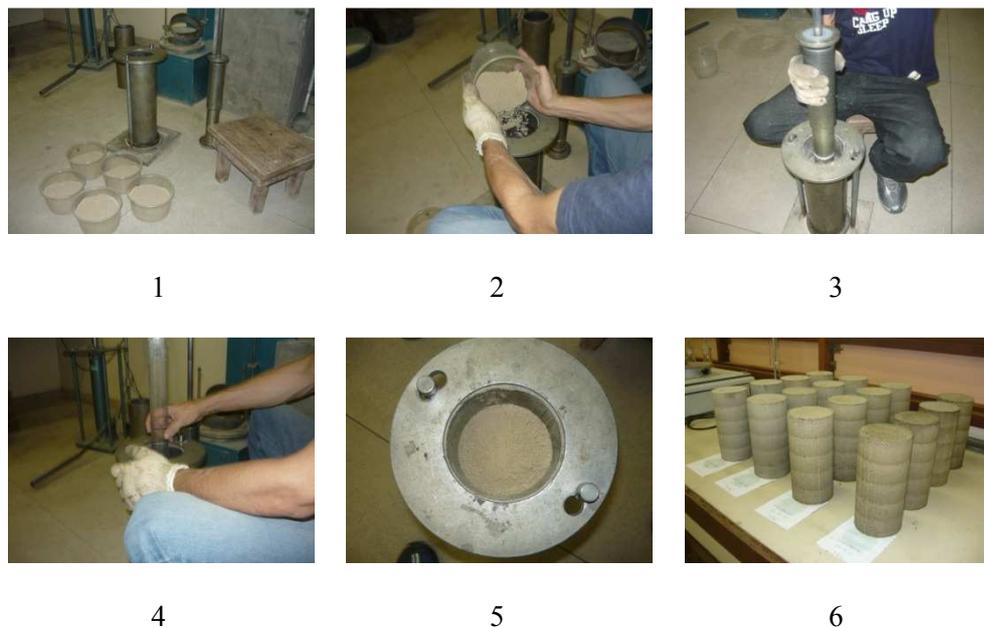
Figura 4.7 – Procedimento de moldagem para determinação da RCS
