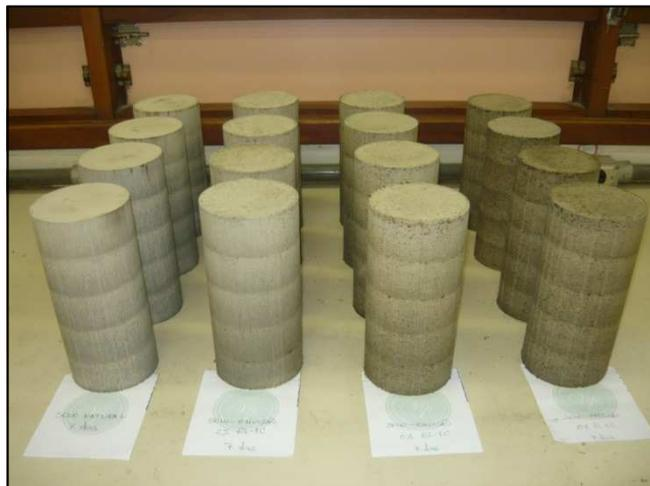
Figura 4.6 – Corpos-de-prova expostos ao ar livre
