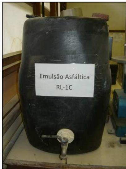
Figura 4.2 – Recipiente com emulsão asfáltica
