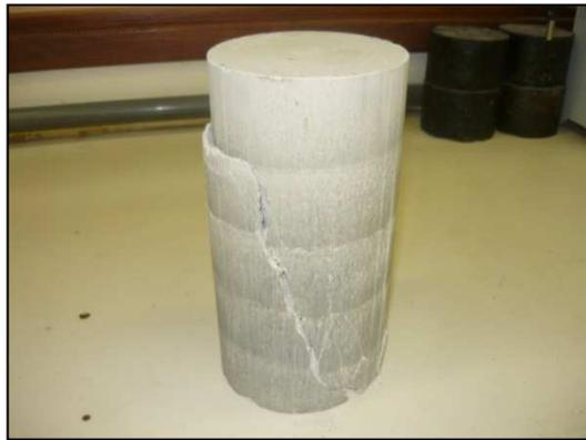
Figura 5.10 – Padrão de ruptura após o ensaio de RCS
