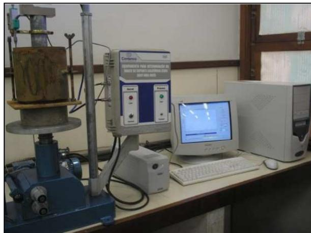
Figura 4.5 – Equipamento para determinação do Índice de Suporte Califórnia
