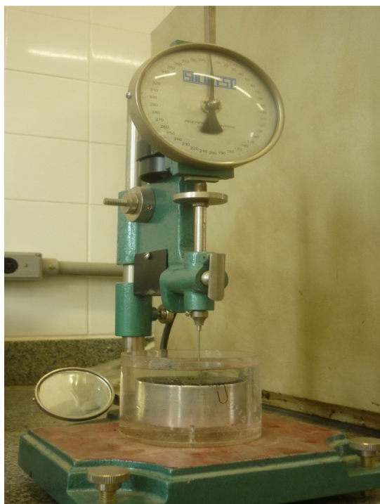
Figura 17: de penetração realizado no Laboratório de Pavimentos da COOPE/UFRJ.
