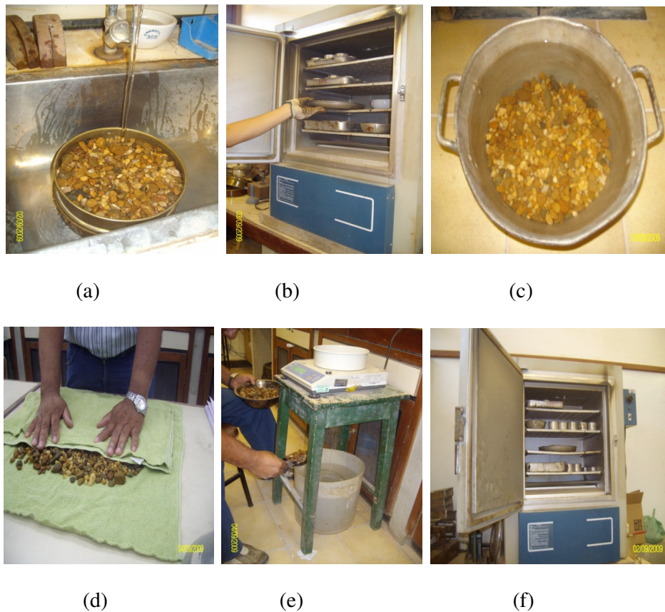
Figura 12: Etapas do ensaio de absorção: a) lavagem do seixo na peneira (4,8 mm); b) secagem em estufa até a constância de massa; c) imersão em água por 24 h; d) remoção da água com pano absorvente; e) pesagem do seixo submerso em água; f) secagem em estufa.
