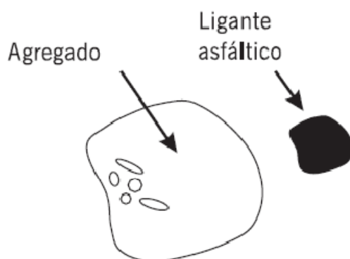
Figura 19: Volumes para a Densidade Máxima Teórica (DMT).
