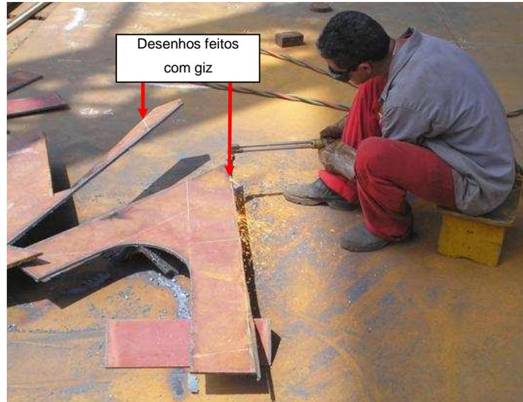
Figura 28: Desenho e corte manual
