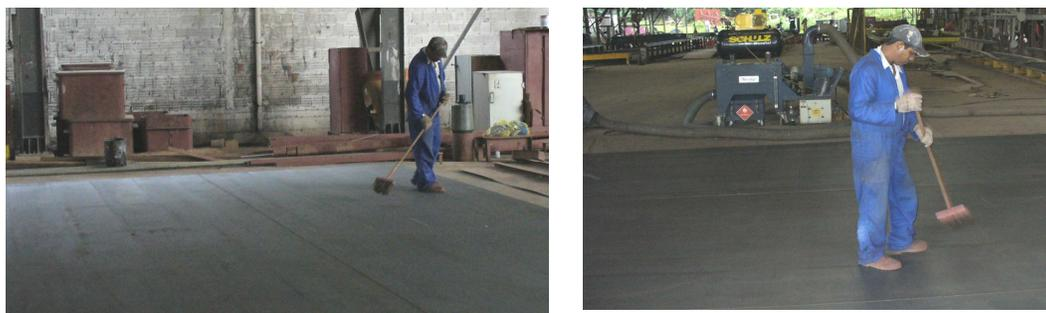
Figura 24 A e B: Limpeza da superfície da chapa
