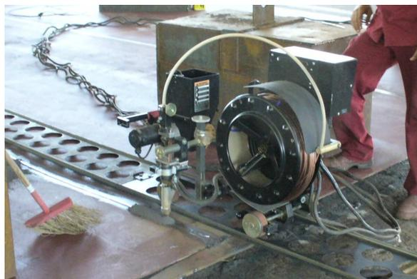
Figura 15: Máquina de solda por arco submerso
