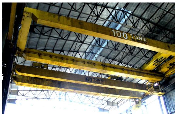
Figura 12: Pontes rolantes usadas para movimentar os painéis e os blocos
