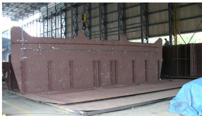
Figura 35: Montagem de um bloco
