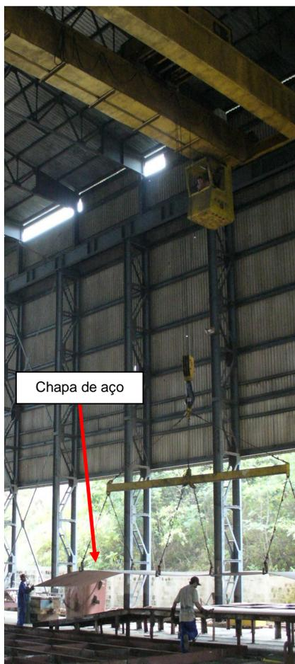
Figura 27 B: Uso da ponte rolante para movimentar as chapas
