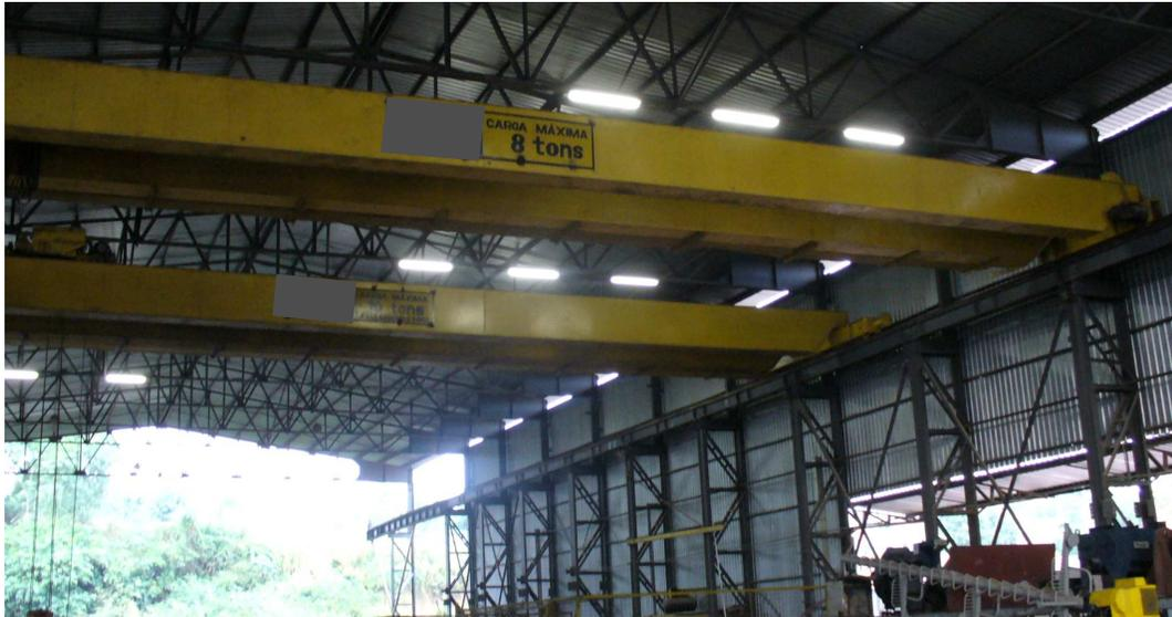
Figura 10: Pontes rolantes para movimentação das chapas de aço
