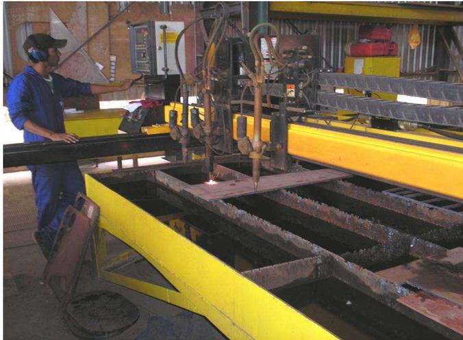
Figura 29: Máquina de corte ESAB, cortes retos e curvilíneos
