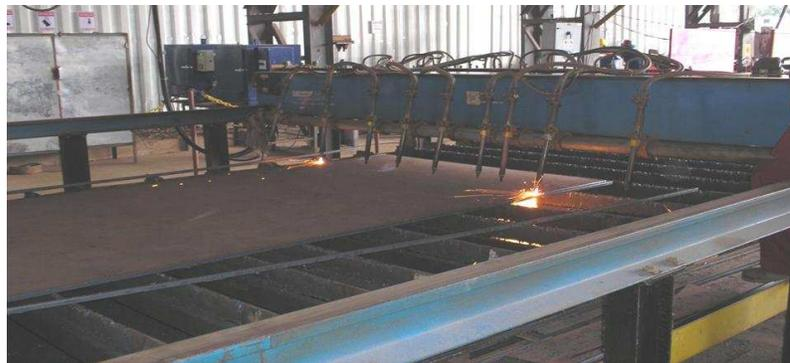
Figura 30: Máquina de corte SMF, apenas cortes retos
