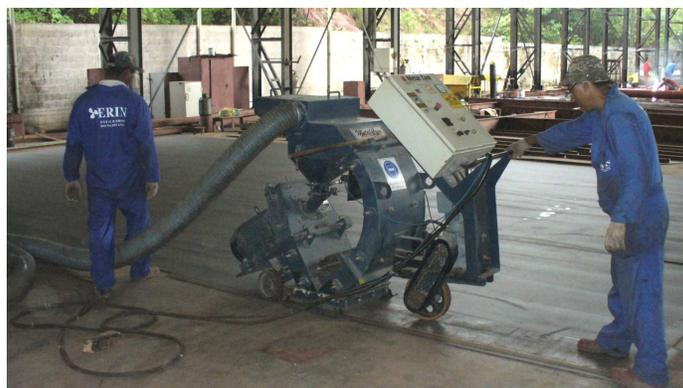
Figura 23: Jateamento da superfície das chapas de aço
