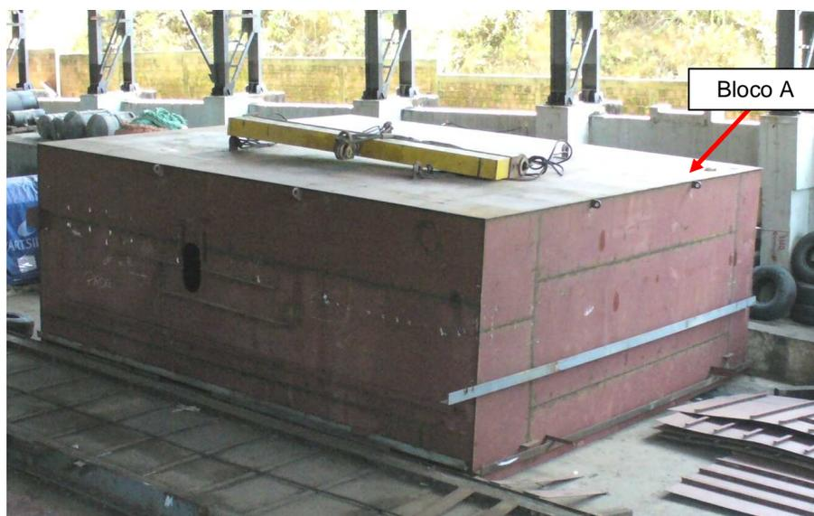
Figura 39: Bloco que será montado na embarcação
