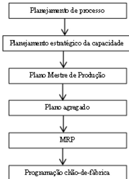
Figura 6 - Estrutura geral do sistema de PCP para manufatura
