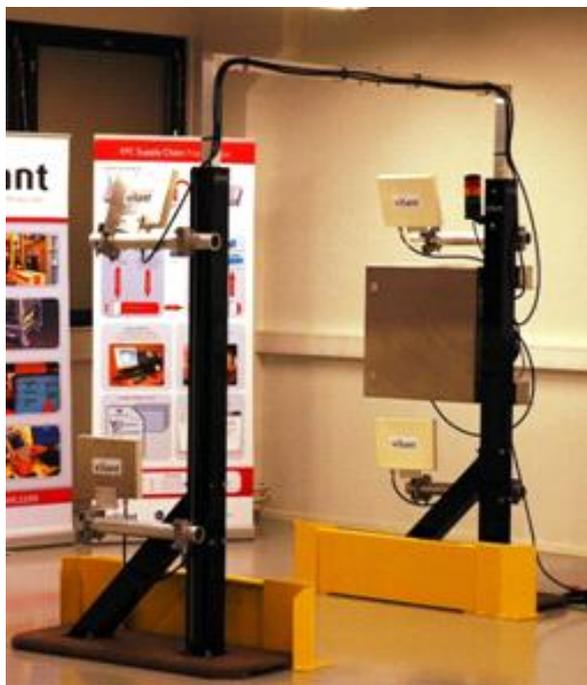
Figura 6 – Modelo de portal RFID usado pela empresa.
