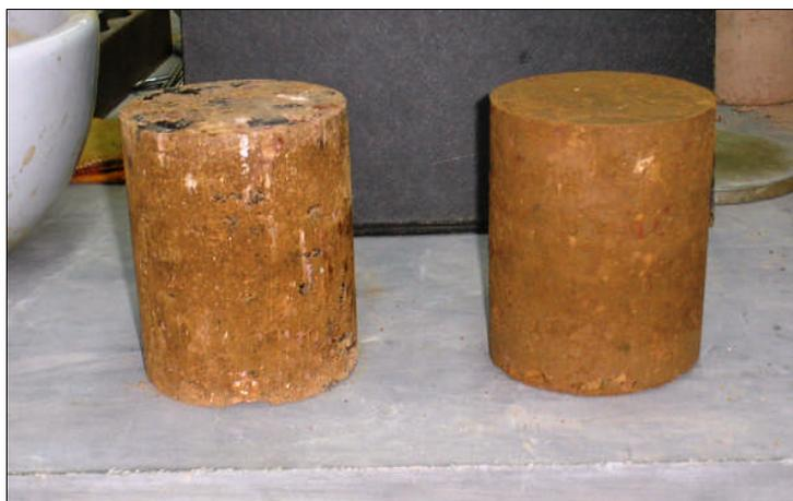
Figura 4.1: Copos de prova prontos para o ensaio de resistência à ruptura, o da esquerda é da mistura reciclada (solo+asfalto) e o da direita é solo A-2-5 com presença de material laterítico miúdo.
