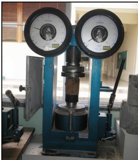
Figura 4.2: Teste de resistência do material reciclado em prensa manual.
