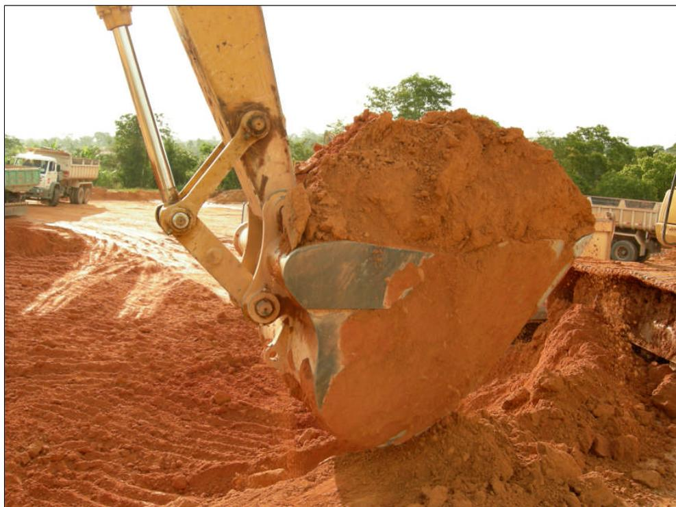
Figura 4.4: Detalhe da concha da escavadeira com “capacidade coroada”.
