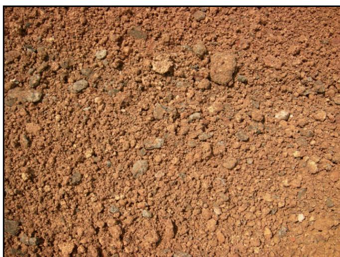
Figura 4.22: Material de base reciclado, mistura solo + asfalto, AM-010.
