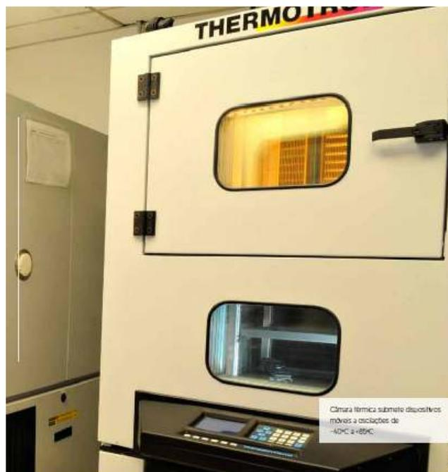
**Figura 21** - Estufa utilizada nos testes climáticos
