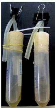
**Figura 6:** Sistema para teste de fermentação qualitativo, alternativo ao teste com tubo de Durham.
