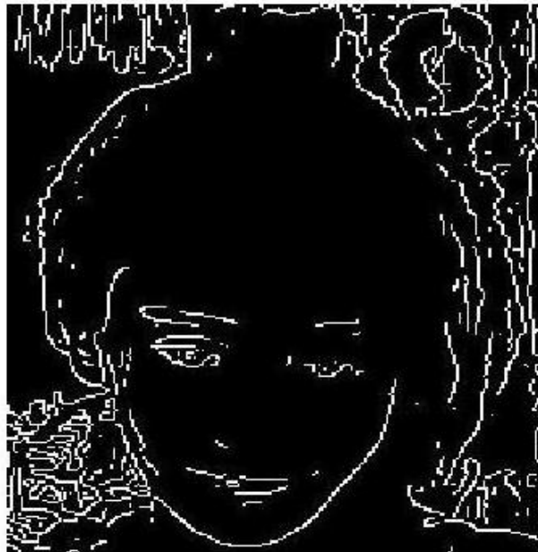
Figura 5.5: Detecção usando método de Canny dobrando a amostragem.
