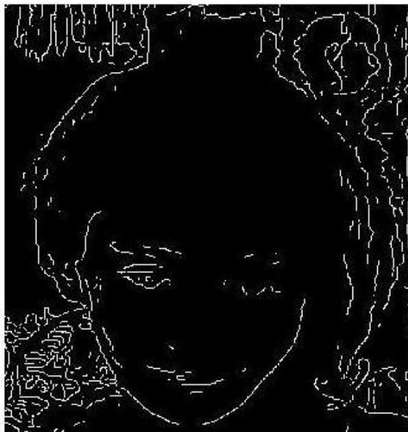
Figura 5.5: Detecção usando método de Canny dobrando a amostragem.
