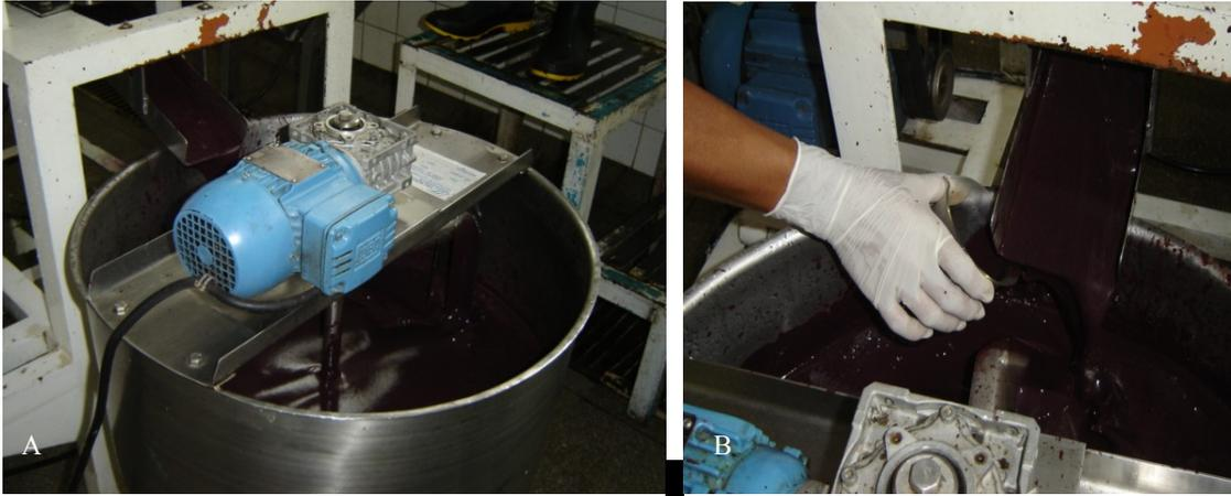
**Figura 18** – A) Tanque homogeneizador. B) Retirada de amostra para confirmação do teor de sólidos totais
