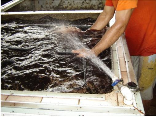
**Figura 13** – Açai nos tanques de lavagem, acondicionados em cestas plásticas e em constante agitação
