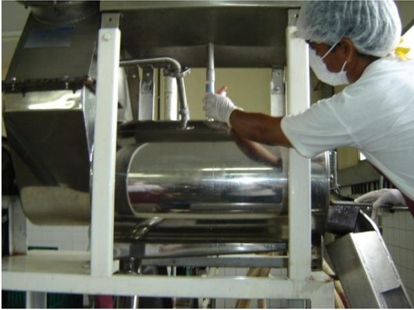
**Figura 17** - Sistema de liberação de água para a máquina de despolar açai sendo acionado
