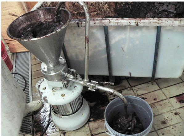
**Figura 24** - Passagem do açaí pelo moinho coloidal para seccionar as fibras
