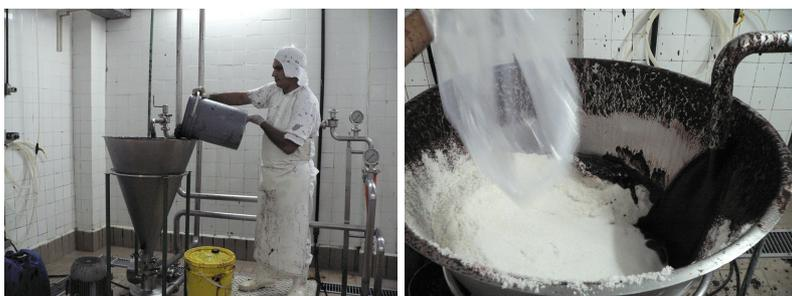
**Figura 25.** Elaboração da formulação no triblender. A) adição do açaí. B) adição de ácido cítrico
