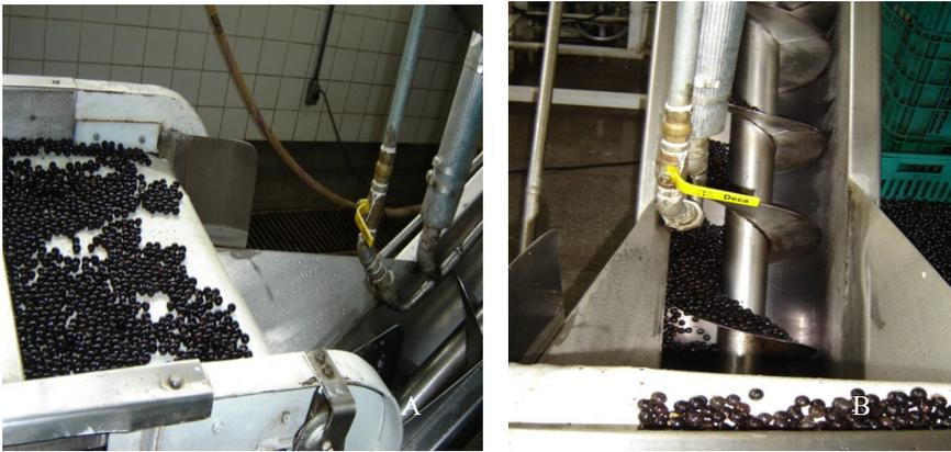
**Figura 16** – A) Esteira conduzindo os frutos de açaí ao elevador. B) Elevador conduzindo os frutos à máquina de despolda.
