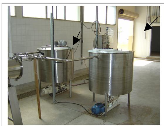
**Figura 28** – Tanques de recepção do açaí pasteurizado (pulmões) com tampas removíveis, que abastece a embaladora e no destaque, a abertura que dá acesso direto ao meio externo da fábrica.
