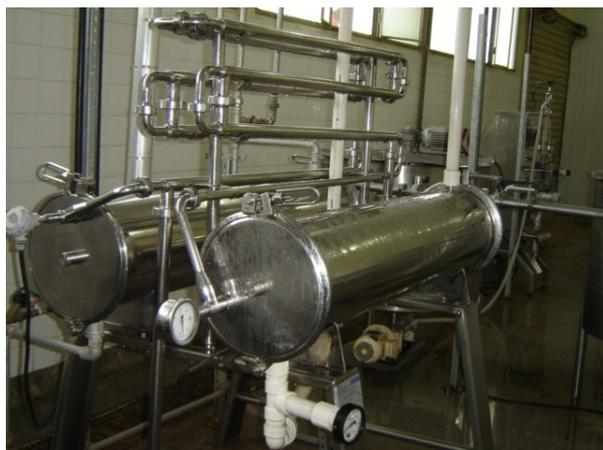
**Figura 19** – Equipamento utilizado na pasteurização do açaí em Codajás- AM
