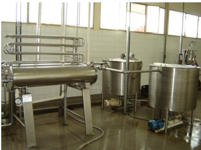
**Figura 20** – Tanques pulmão de abastecimento
