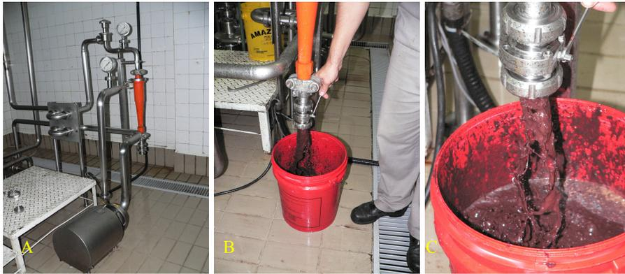
**Figura 26** - A) Equipamento Hidrociclone; B) passagem do suco tropical de açaí pelo hidrociclone; C) Material descartado pelo hidrociclone.
