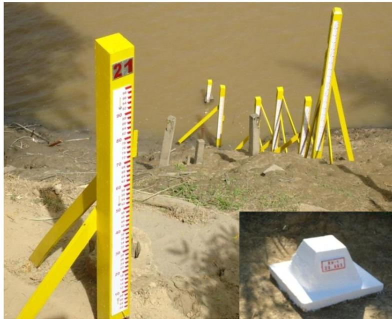
**Figura 2:** Réguas linimétricas e RN fixado a poucos metros da ultima régua da estação fluviométrica de Abuña (RO). Fonte: Muniz, 2011.
