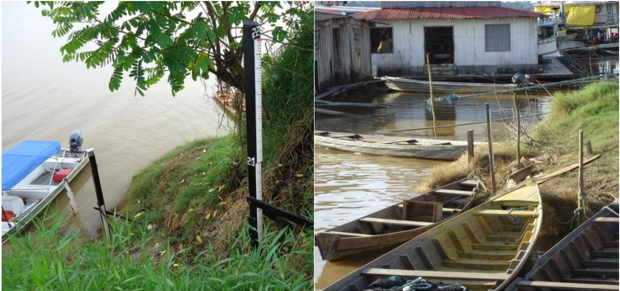
**Figura 36:** A esquerda foto da estação de Borba (AM) localizada em encosta muito íngreme de difícil acesso o que dificulta o trabalho do observador e a direita a estação de Manicoré (AM) sem várias régua foram removidas pela dinâmica fluvial e ou tombadas devido aos barcos. Fonte: Muniz, 2011.
