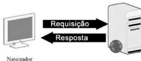
**Figura 2.3.** Interação entre cliente e servidor.
