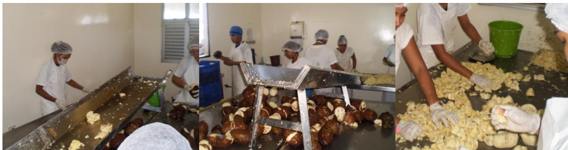
Figura 23: Esteira não mecânica e separação das fibras e sementes. Itacoatiara/AM, 2012/2013. Foto: Socorro Moraes Nina.
