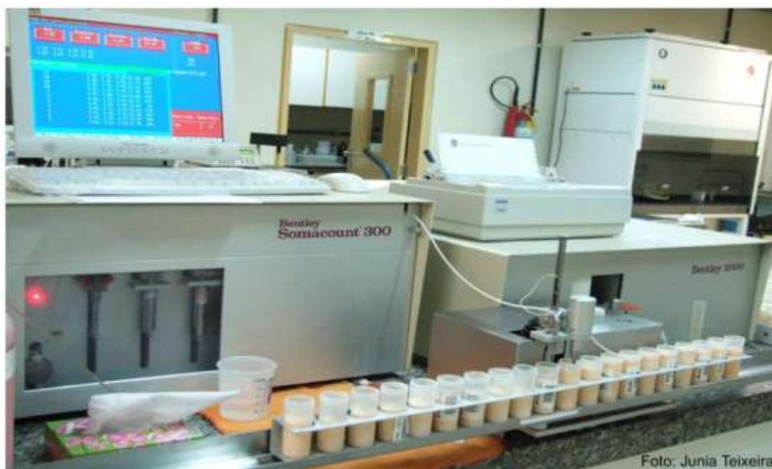
Figura 4. Foto do equipamento eletrônico Somacount 300 da Bentley Instruments Incorporated®, Chaska, Estados Unidos da América, para contagem de células somáticas em amostras de leite.
