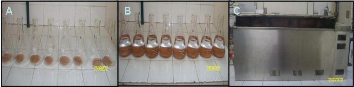
Figura 7 – Extração em água quente; A – amostras identificadas; B – Amostras imersas em água destilada; C – Amostras em Banho maria.
