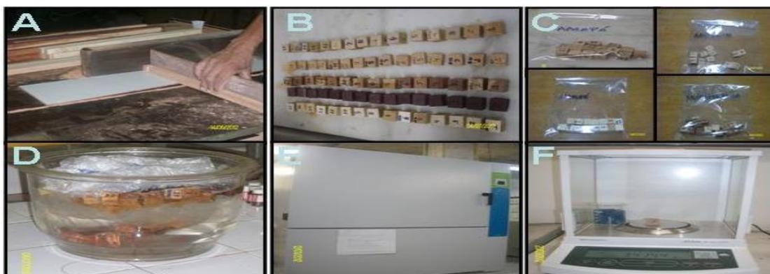
Figura 4 - A- Corte dos resíduos para análise amostras; B - Identificação das amostras; C - Separação e identificação em sacos plásticos; D- imersão em água; E - secagem em estufa; F- Pesagem das amostras.
