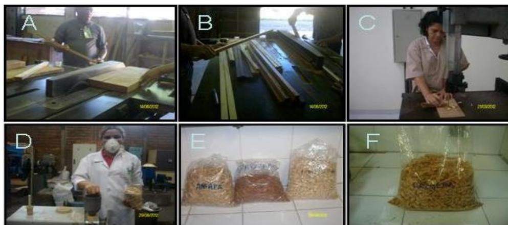
**Figura 3. Etapas do processo. A - Corte dos resíduos - B- Separação das peças - C- corte de peças menores na serra de fita- D - Moagem dos resíduos - E e F - separação dos resíduos por espécie.**
