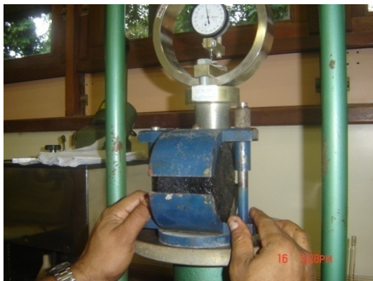
Figura 16 – Ensaio de Estabilidade e Fluência do CBUQ
