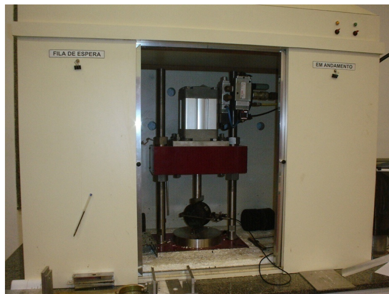
Figura 18 – Ensaio módulo de resiliência do CBUQ
