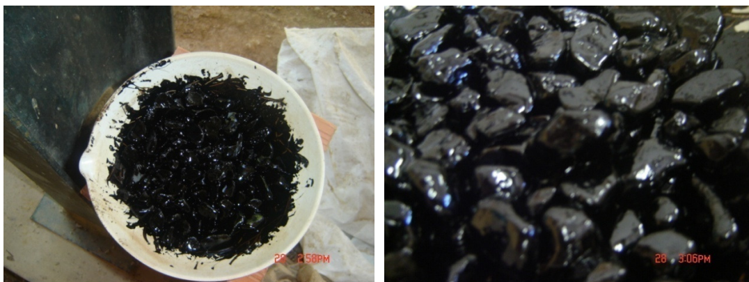
Figura 11– Envolvimento dos agregados calcinados ao ligante
