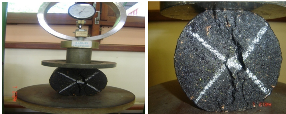
Figura 17 – Ensaio de resistência à tração por compressão diametral
