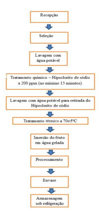
Fig. 01. Fluxograma sugerido para o processamento da polpa
