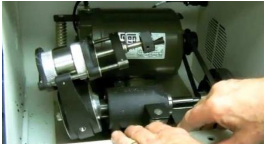
Figura 6 – moinho vibratório SPEX (modelo 8000) com cilindro fixado.
