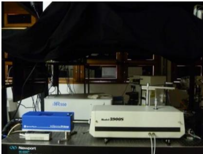
Figura 7 - Espectrômetro Jobin Yvon iHR550
