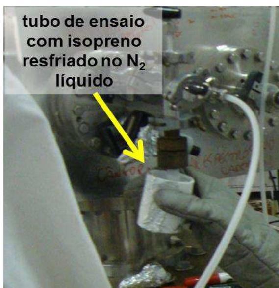
**Figura 6.** Imagem do sistema de injeção de amostra, mostrando em destaque o local em que foi fixado o tubo de ensaio com isopreno resfriado em nitrogênio líquido.
