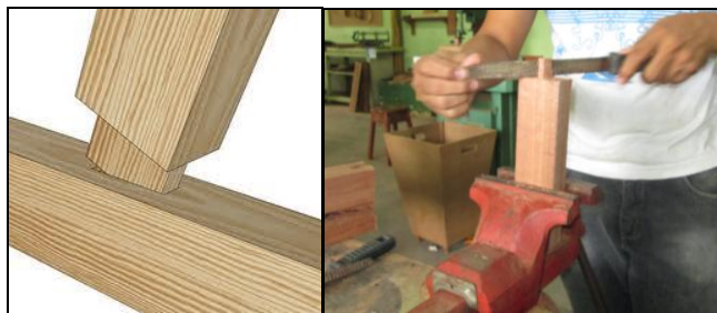
Figura 36. Esquema técnico de um encaixe tipo espiga (à esq.) e espiga no braço da poltrona (à dir.).
