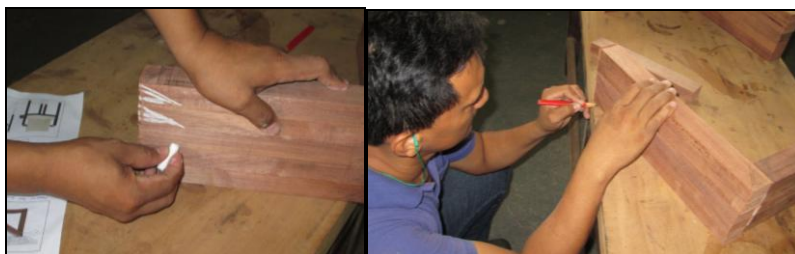
Figura 59. Operador medindo a área a ser cortada para sambladura.
