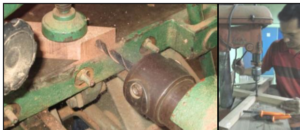
Figura 23. Processo de furação em furadeira horizontal (à esq.) e vertical (à dir.).
