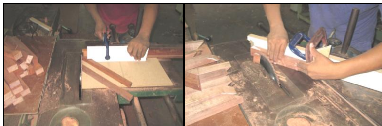
Figura 30. Confeção de gabarito para sambladuras (à esq.) e execução do corte de sambladura (à dir.).
