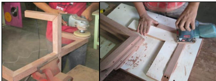
Figura 24. Lixamento com lixadeira de disco (à esq.) e lixadeira orbital (à dir.).
