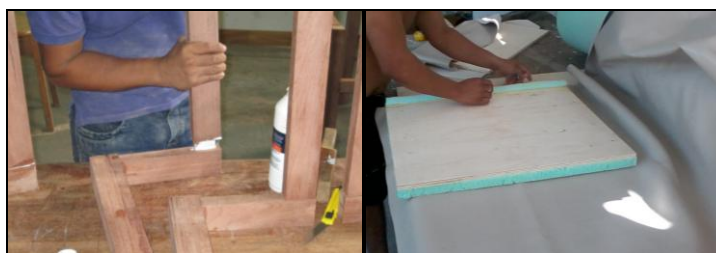
Figura 37. Colagem e montagem dos braços da poltrona (à esq.) e montagem do assento (à dir.).
