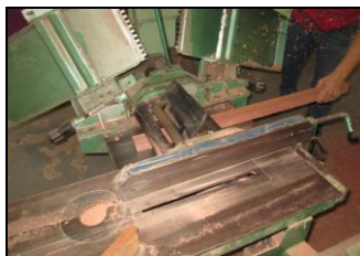
Figura 33. Operação de desengrosso nas peças de madeira.
