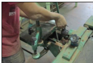
Figura 60. Ajustando a furadeira horizontal.
