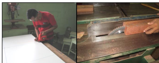
Figura 18. Corte com serra tico-tico (à esq.) e corte com serra circular (à dir.).
