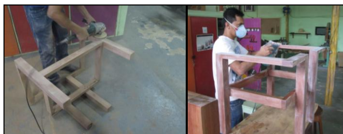
Figura 38. Lixamento em lixadeira de disco (à esq.) e lixadeira orbital (à dir.).
