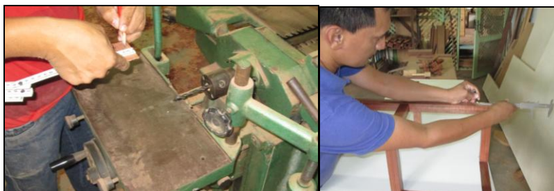
Figura 47. Marcação dos locais do furo.
