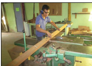
Figura 55. Desdobro da peça de madeira.
