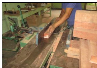
Figura 32. Aplainamento da peça de madeira.
