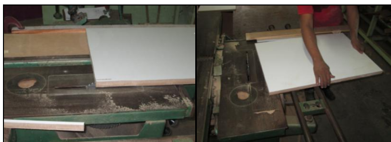
Figura 45. Esquadrejamento do tampo da mesa (painel MDF).
