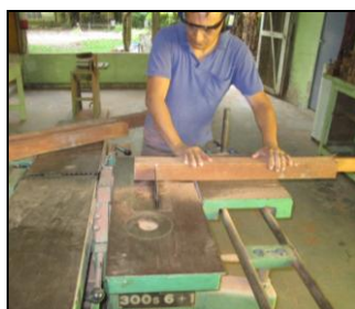
Figura 21. Esquadreamento em peça de madeira.
