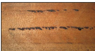
Figura 11. Canais axiais traumáticos nas peças de tauari-vermelho. Fonte: O autor.
