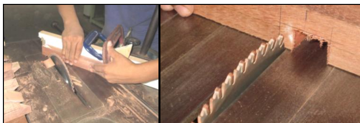
Figura 22. Corte de sambladura (à esq.) e corte de união à meia madeira (à dir.).
