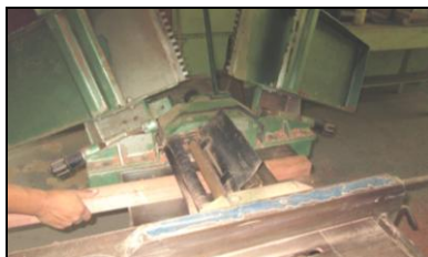
Figura 20. Operação de desgrosso nas peças de madeira.
