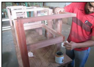
Figura 39. Aplicação de selador na poltrona.
