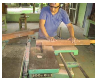
Figura 34. Esquadreamento em peça de madeira.
