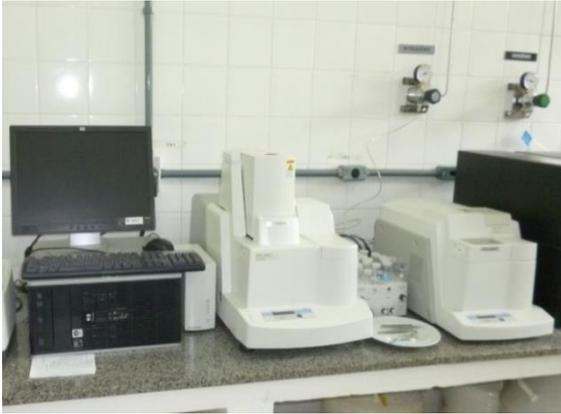
**Figura 9.** Termonalisador TGA/DTA Shimadzu, modelo DTG-60H, do Laboratório de Pesquisa e Análise de Combustível - LAPEC/UFAM.
