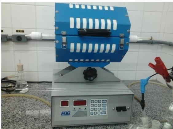
**Figura 8.** Forno tubular EDG, modelo FC-23P, do Laboratório de Pesquisa e Análise de Combustível – LAPEC/UFAM.
