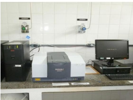
**Figura 10.** Espectrômetro de infravermelho com transformada de Fourier da Thermo Scientific, modelo Nicolet IR 200, do Laboratório de Pesquisas e Ensaios de Combustíveis-LAPEC/UFAM.
