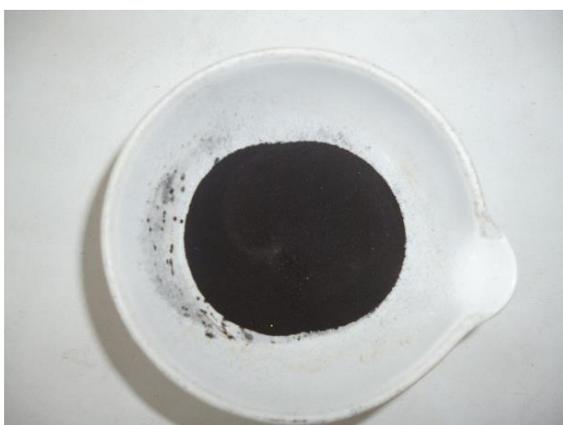
**Figura 17.** Amostra de CA, seco e triturado, obtido por pirólise da borra oleosa.
