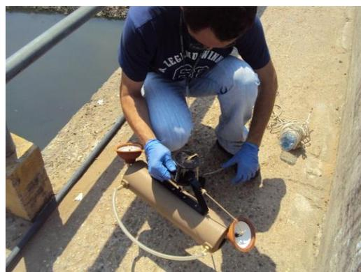
**Figura 9:** Garrafa VanDorn utilizada na coleta das amostras de água e efluentes hospitalares
