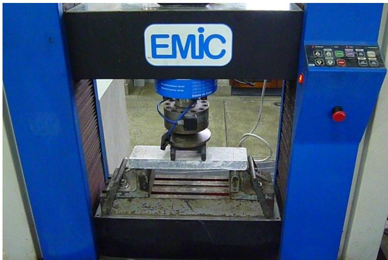
Figura 25: Prensa EMIC utilizada nos ensaios de flexão.
