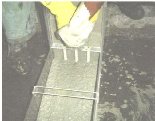
Figura 22: Ensaio da caixa L em andamento (fonte: Tutikian e Dal Molin, 2008, p 55).
