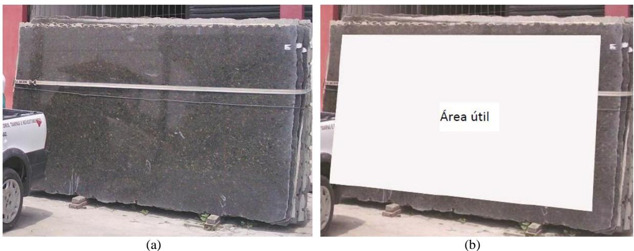
Figura 4: Placa de granito a ser cortada: (a) Placa no pátio; (b) área útil da placa, bordas que são cortadas.
