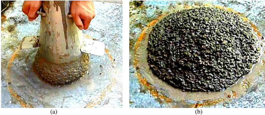
Figura 19: Ensaio do Slump flow T50cm: (a) início do ensaio slump flow; (b) mede-se o tempo para alcançar diâmetro igual a 500 mm.
