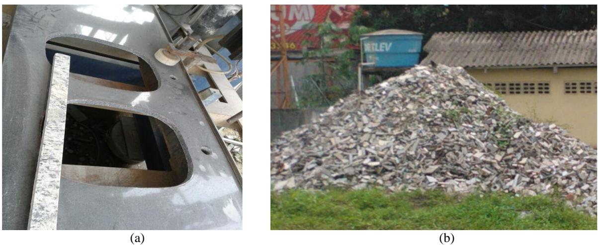
Figura 6: : Produtos finais do corte da placa: (a) Peça projetada; (b) Aparas de mármore e granitos provenientes do corte de placas
