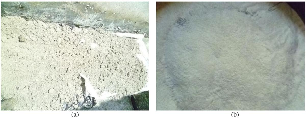
Figura 11: Preparação dos resíduos: (a) Aspecto dos resíduos após passar pelo moinho; (b) RMG com diâmetro menor que 0,075mm.
