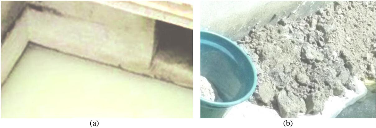
Figura 7: Resíduo na forma de lama e pó: (a) Tanque de decantação da lama; (b) Aspecto do resíduo fino - pó - deixado secar.
