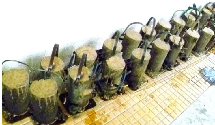
Figura 16: Corpos de prova moldados
