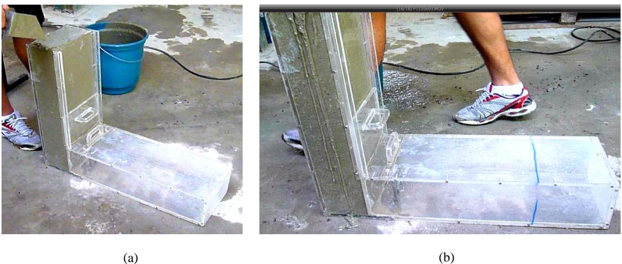
Figura 41: Ensaio de habilidade passante na caixa L: (a) Caixa L com a parte vertical contendo concreto; (b) Marcação de 40 cm na caixa L.
