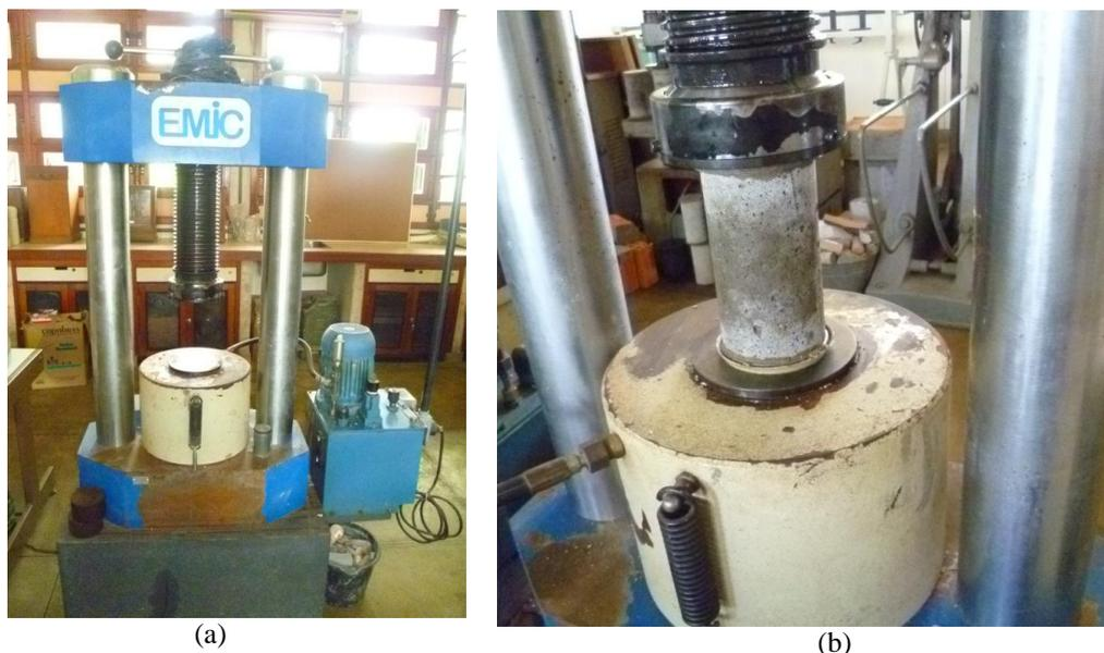
Figura 23: Ensaio de compressão axial simples: (a) Prensa utilizada, capacidade = 300 KN; (b) Corpo de prova sendo prensado.
