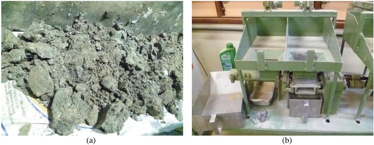
Figura 10: Preparação dos resíduos das marmorarias: (a) Pré-secagem da lama proveniente dos tanques de decantação das empresas; (b) Moinho de mandíbulas utilizado para triturar e separar os grãos de RMG.
