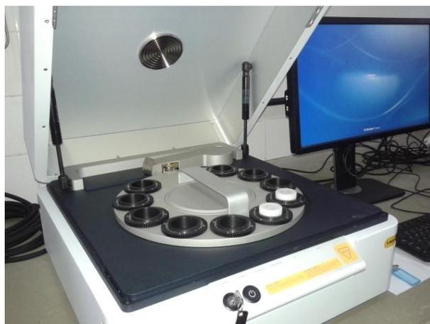
Figura 12: Equipamento de espectroscopia por fluorescência de raios X.
