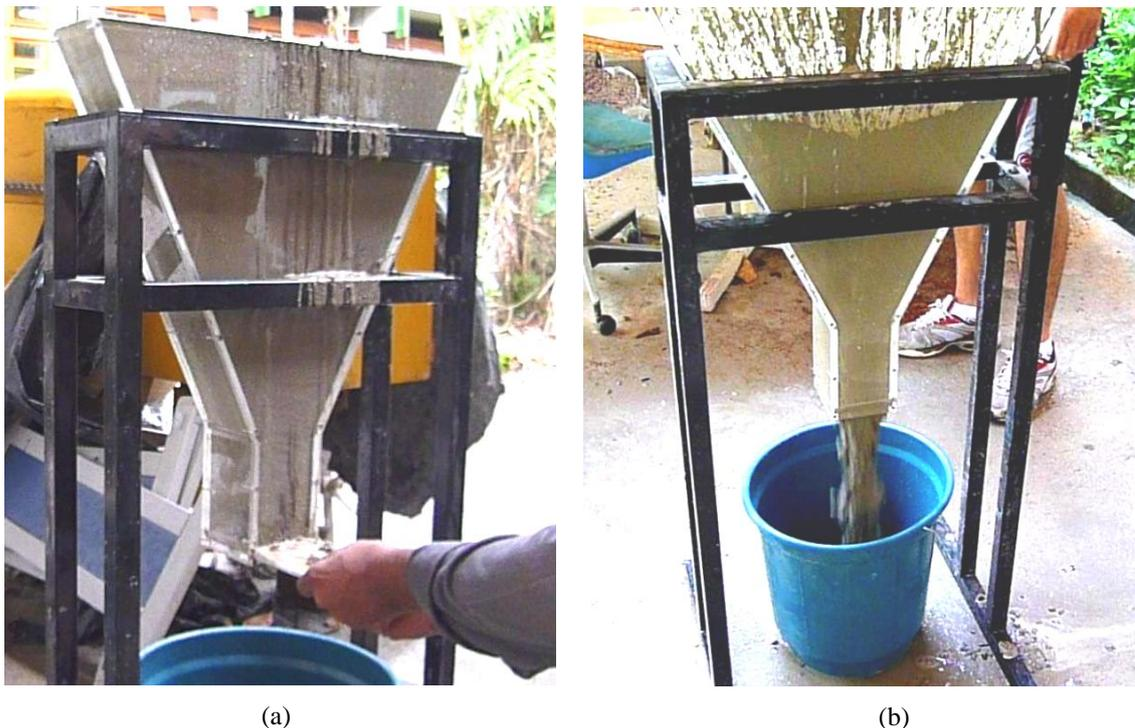
Figura 39: Ensaio de fluidez no funil "V": (a) Abertura da porta do funil "V"; (b) Escoamento do material.
