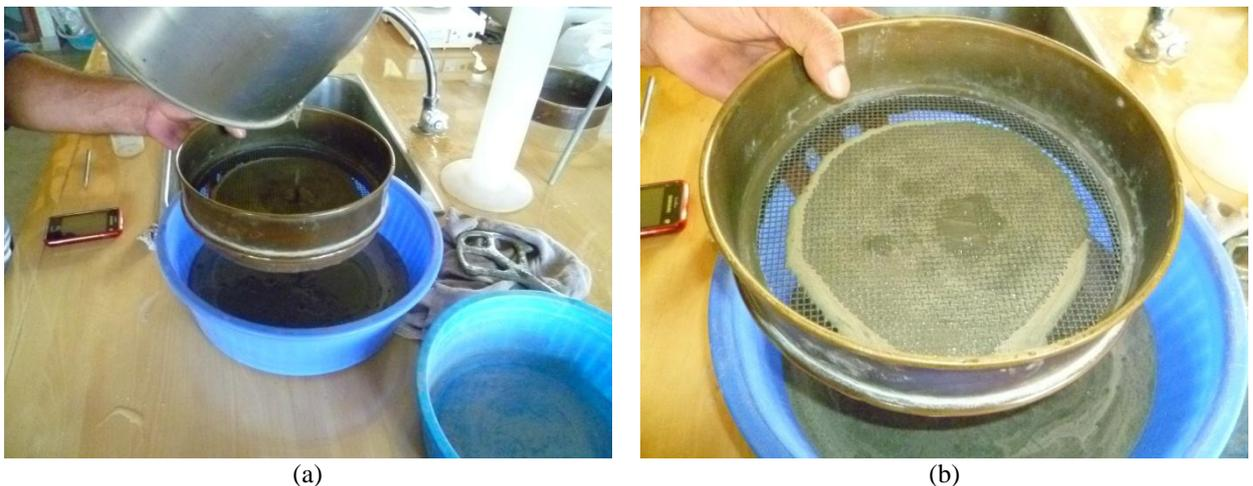
Figura 15: Preparação da pasta de cimento para ensaio no funil de marsh: (a) Peneiramento na peneira 2,4 mm; (b) Material retido na peneira e que deve ser descartado.
