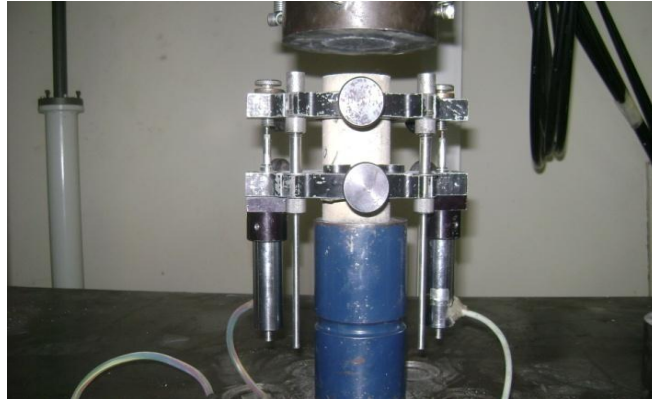
Figura 49: Detalhes dos LVDTs e sua fixação no corpo-de-prova.
