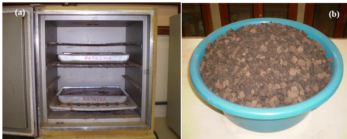
Figura 18: (a) Lodo na estufa; (b) Amostra de lodo seco a 110 ^\circ\text{C} .
