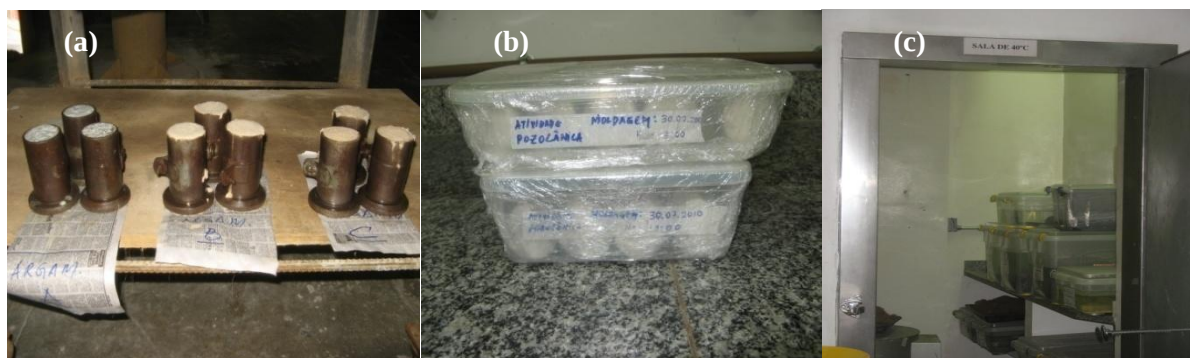
Figura 41: (a) Corpos-de-prova em processo de cura; (b) Corpos-de-prova selados; (c) Corpos-de-prova armazenados em câmara a 40 °C durante 27 dias.
