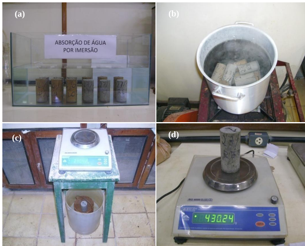
Figura 50: (a) Imersão total dos corpos-de-prova por 72 horas; (b) Corpos-de-prova em ebulição após 72 h imersos; (c) Pesagem de corpo-de-prova em balança hidrostática; (d) Pesagem de corpo-de-prova saturado com superfície seca.
