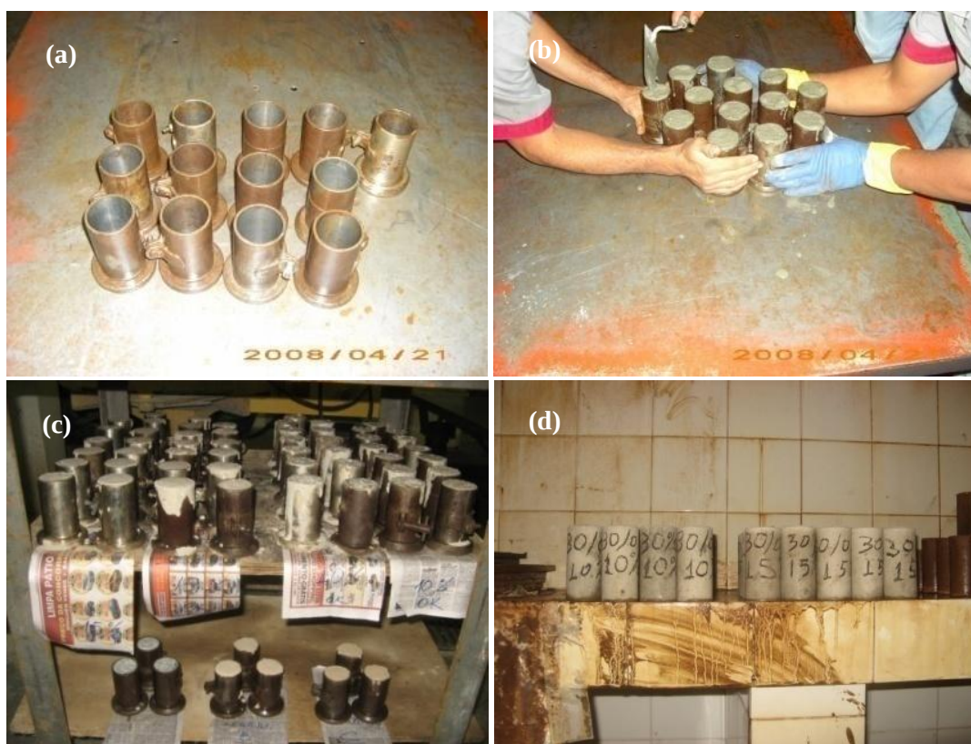
Figura 46: (a) Moldes cilíndricos 5 x 10 cm; (b) Adensamento da mistura em mesa vibratória; (c) Armazenagem dos corpos-de-prova para cura úmida; (d) Corpos-de-prova em câmara úmida.
