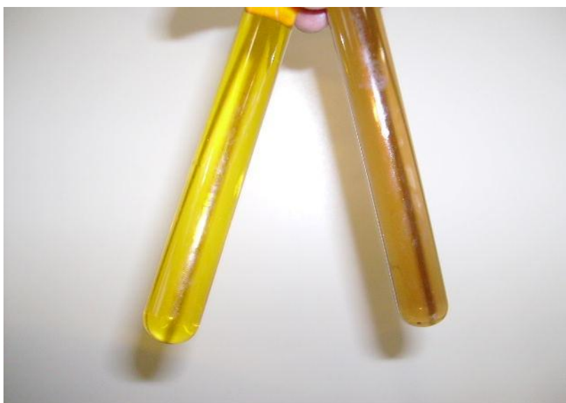
Figura 59: Solução padrão: mais clara; e solução com amostra: mais escura.
