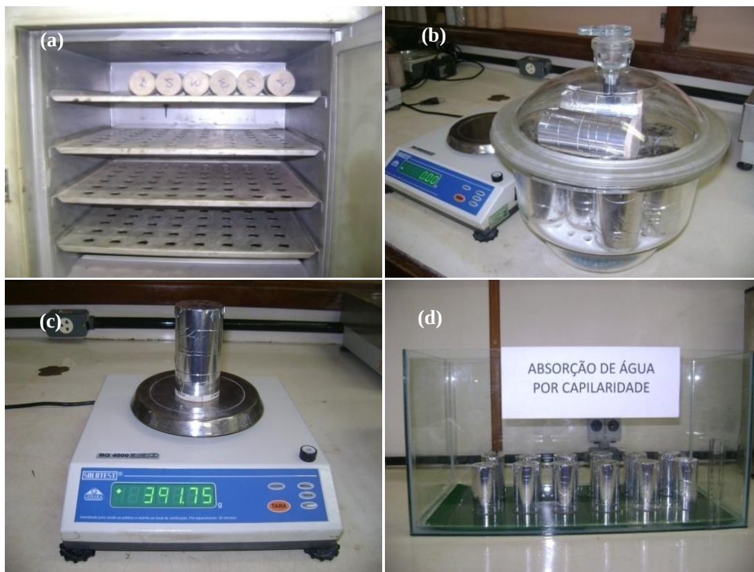
Figura 51: (a) Secagem de corpo-de-prova em estufa; (b) Corpos-de-prova em dessecador para resfriamento; (c) Pesagem do corpo-de-prova antes do contato com a água; (d) Corpos-de-prova em contato com lâmina d'água de 5 mm.
