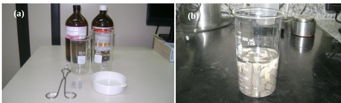
Figura 53: (a) Materiais utilizados para cessar a hidratação das amostras; (b) Amostras imersas em acetona.
