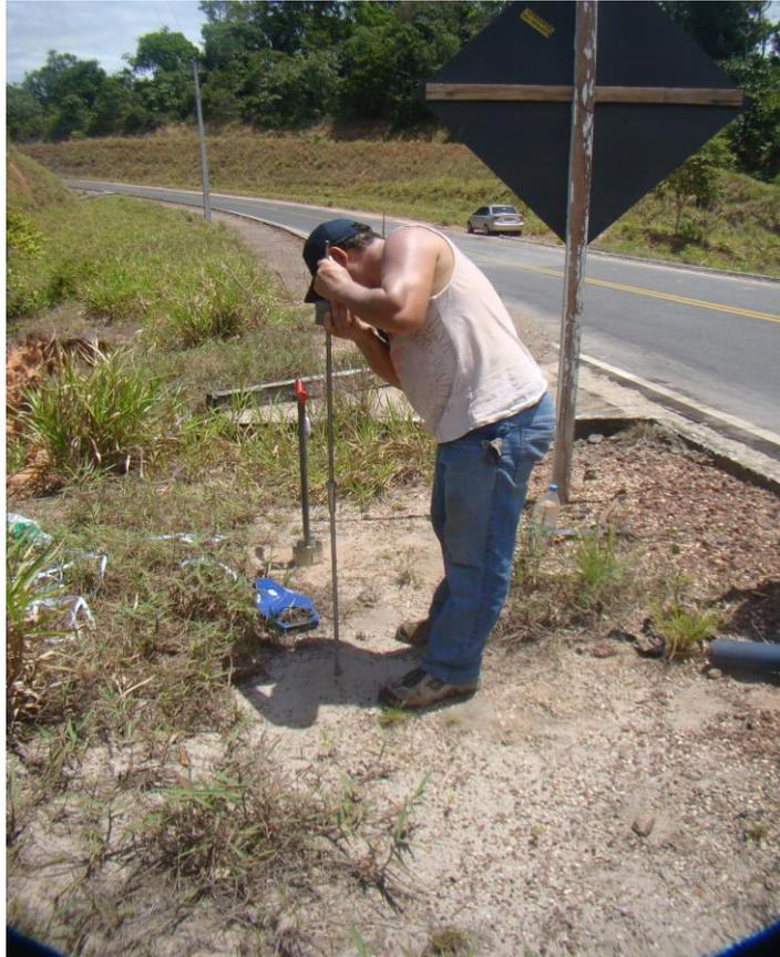
**Figura 13:** Realização do teste da penetração do solo, trabalho de campo realizado em Setembro de 2013.
