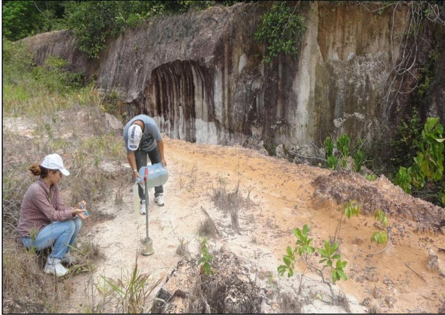
**Figura 12:** Teste de infiltrômetro
