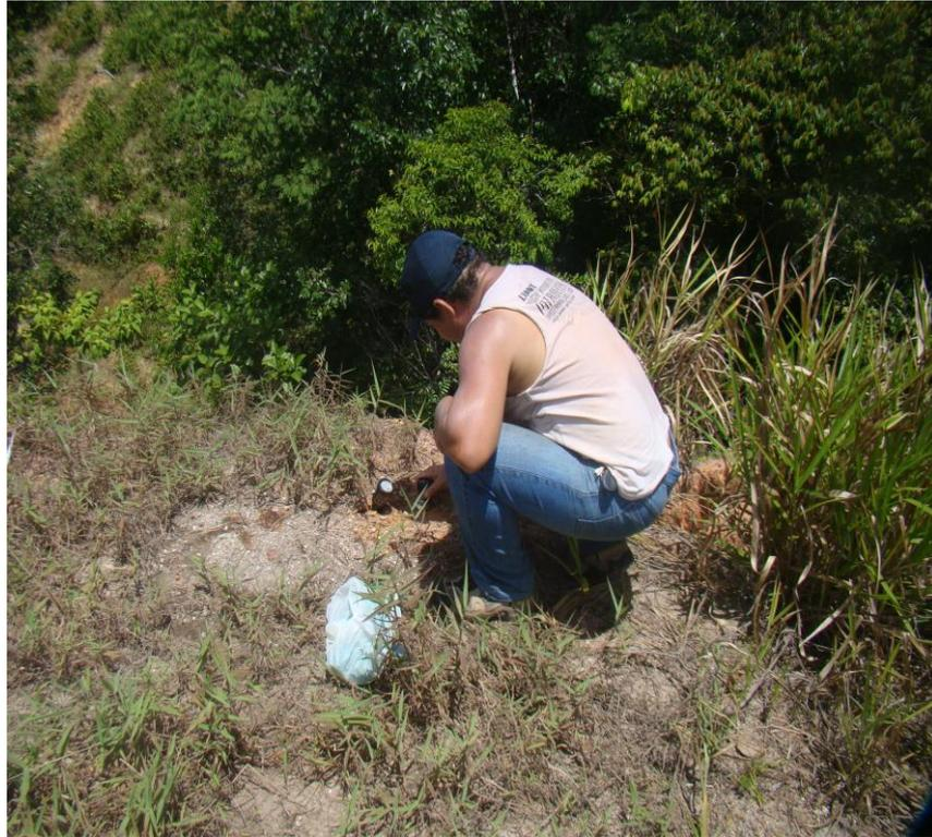
**Figura 14:** Teste do cisalhamento e do pH do solo, trabalho de campo realizado em Setembro de 2013.
