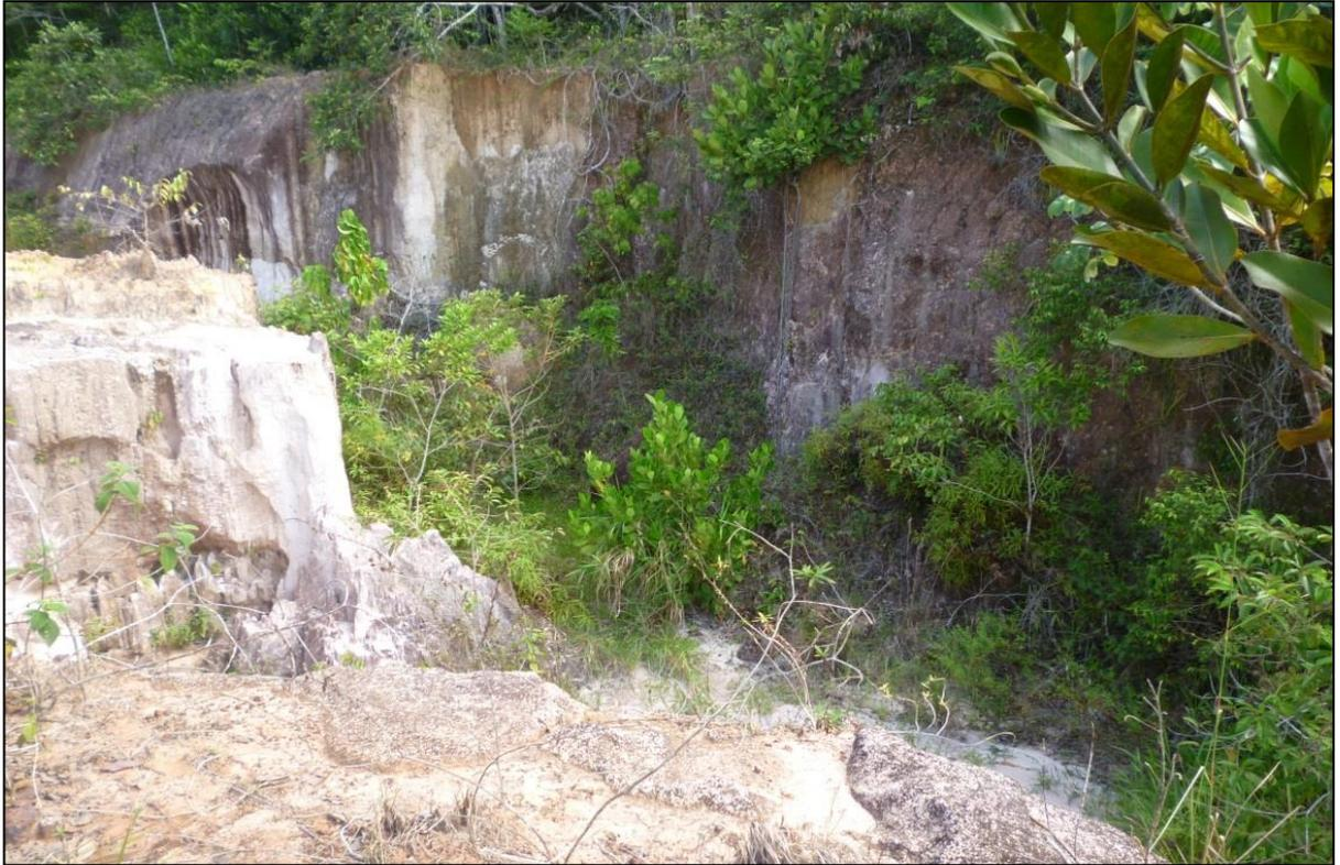
**Figura 34:** Voçoroca com solo encrostado e grande presença de vegetação localizada no km-73 da estrada AM-363 (Setembro de 2013).
