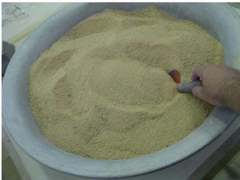
Figura 37 – Preparação das amostras 2, 3 e 4 (misturas do solo *in natura* com areia), utilizando uma pequena pá.
