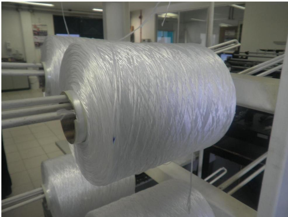
Figura 53 – Fios de poliéster utilizados na fabricação de geogrelha tecida na fábrica da Maccaferri em Camaçari – BA.
