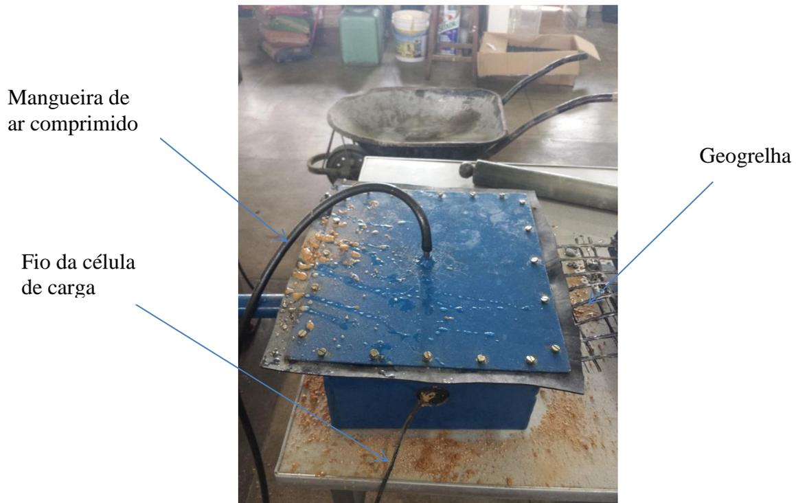
Figura 66 – Tampa com borracha inflável para simular a tensão confinante do solo.
