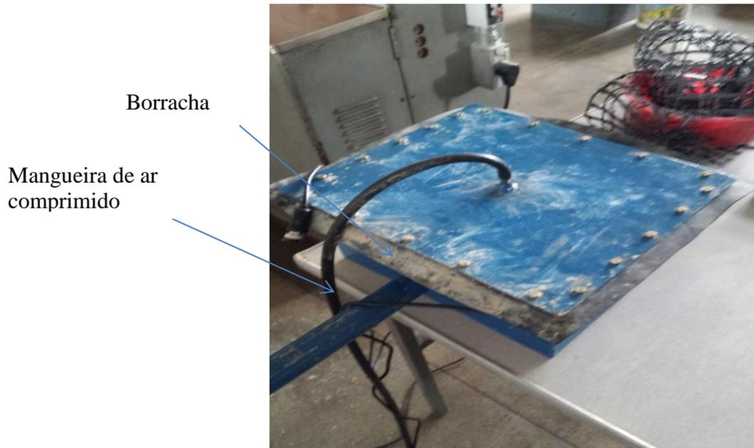
Figura 62 – Borracha que infla, pressionando o solo confinado, com o intuito de simular o confinamento natural do solo.
