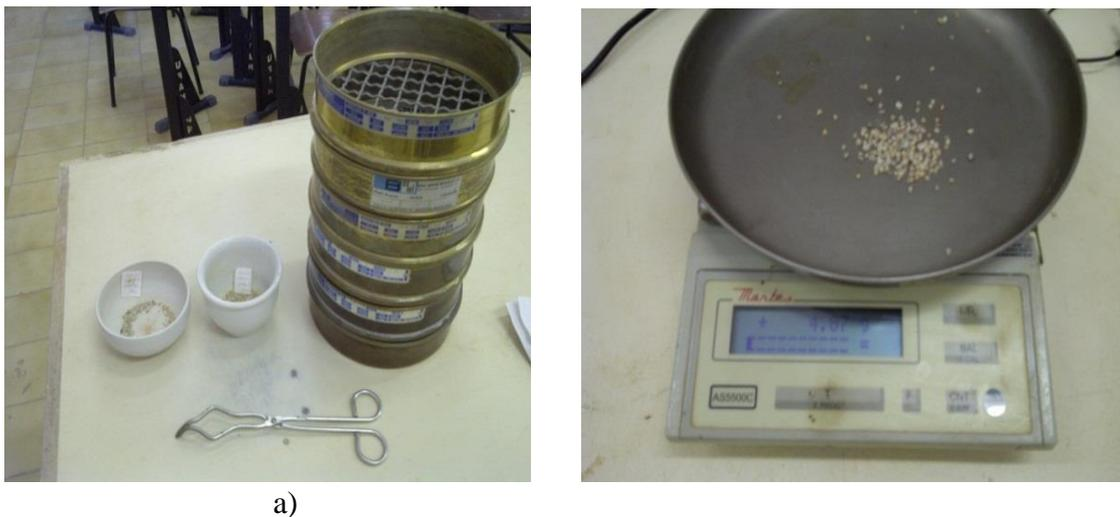
Figura 41 – Ensaio de Peneiramento do material grosso. (a) O material de solo é submetido as peneiras n° 2", 1 ½", 1", ¾", 3/8", 4 e 10. (b) O material de solo retido em cada peneira é pesado.
