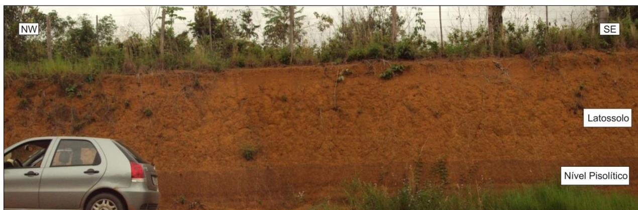
Figura 17 - Latossolo amarelo, de espessura métrica, desenvolvido sobre nível pisolítico, sobreposto por sua vez ao embasamento geológico aflorante na rodovia AM-254 (Ponto ELZ 14).
