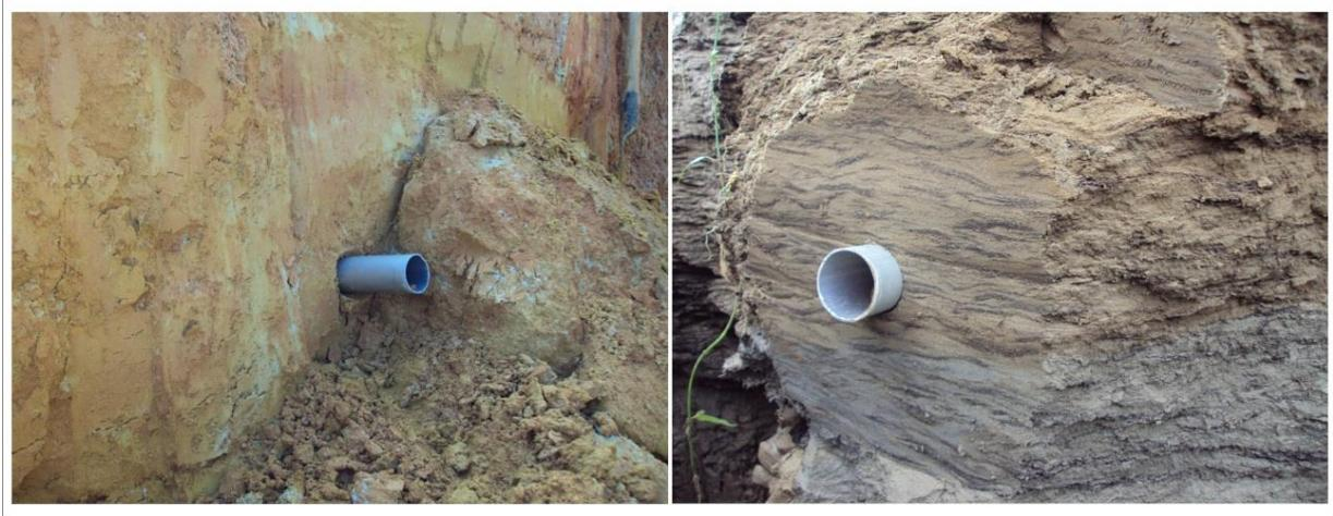
Figura 05 - Coleta de amostras nos terraços do Sistema fluvial Amazonas-Solimões em tubo de alumínio para análises por LOE.
