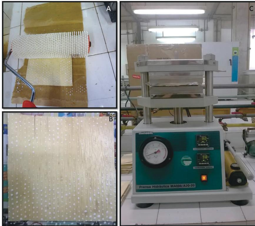
Figura 08. Processo de confecção do painel testemunha, em A e B, aplicação e uniformidade da cola e em C, prensagem do compensado.
