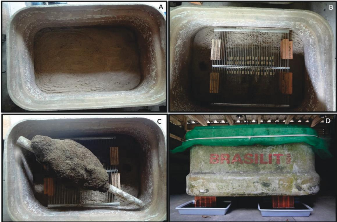
Figura 10. Montagem do ensaio 1. A - Aplicação de 5 cm de camada de areia com umidade ajustada; B - colocação dos corpos de prova e tijolos para servirem de apoio da grelha; C - colônia de cupins sobre a grelha; D - caixa d'água apoiada sobre 4 tijolos dentro de bandejas plásticas. Fotos: Manoel Braga, 2015.
