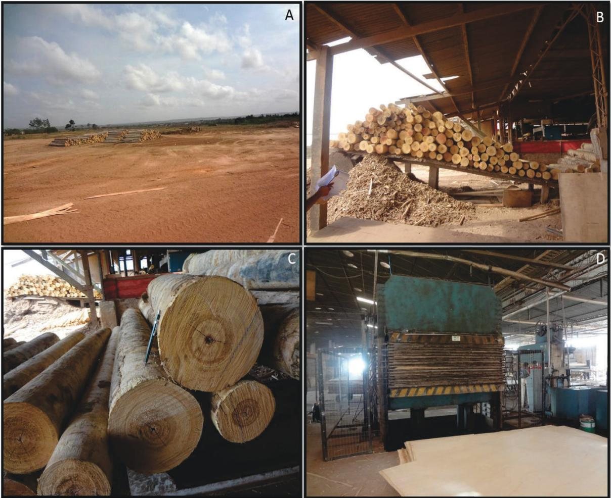
Figura 02. A - Pátio de recebimento de toras; B - descascamento das toras; C - toras de paricá preparadas para laminação; D - prensagem dos painéis compensados. Fotos: Manoel Braga, 2014.
