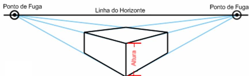
Figura 2 – Pontos de fuga no horizonte. Fonte: [51].
