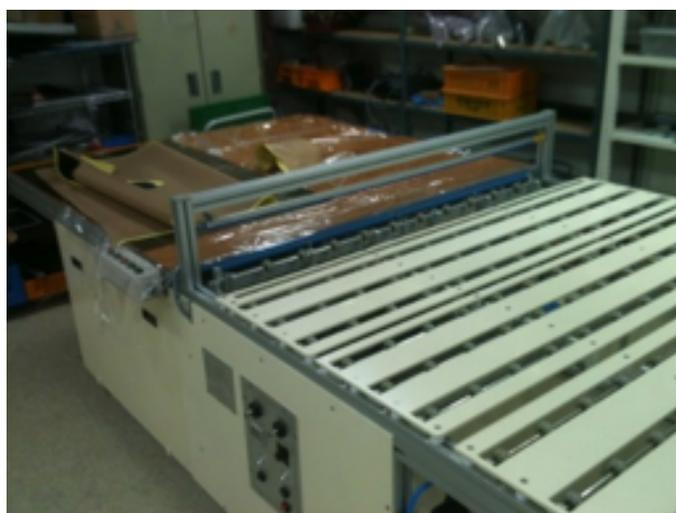
**Figura 46 - Máquina para remoção filme polarizador.**
