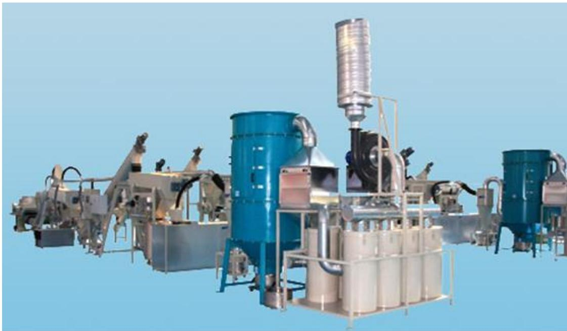
Figura 15: Linha de processadores da Lâmpada da MRT.
