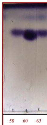
**Figura 11.** Cromatografia em camada delgada da fração CECFR4\_5/58\_63, tendo como eluente Hex/AcOEt 6:4 e como revelador Vanilina Sulfúrica.
