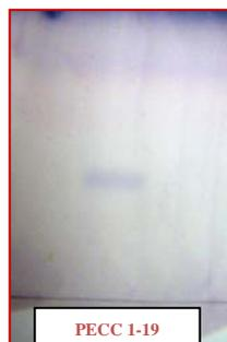
**Figura 14.** Cromatografia em camada delgada da fração PECC 1-19. Utilizando como eluente Hex/AcOEt 1:9 e revelador vanilina sulfúrica.
