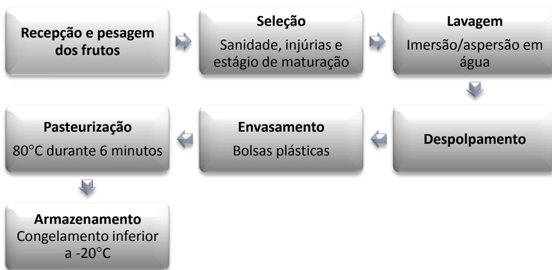
Figura 1 – Fluxograma para obtenção de polpa congelada de araçá de acordo com Ferreira; Gentil (1999).
