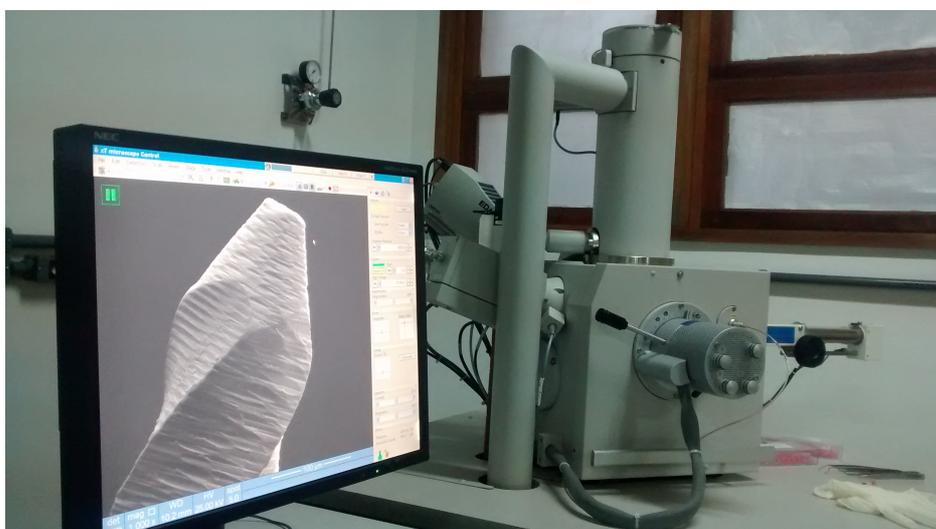
Figura 3: Aquisição das imagens no MEV.
