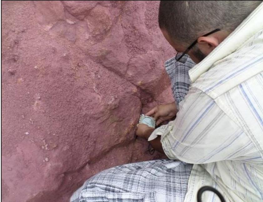
Figura 06: Obtenção dos dados de direção e mergulho das fraturas em campo utilizando a bússola geológica, na margem do Rio Negro.
