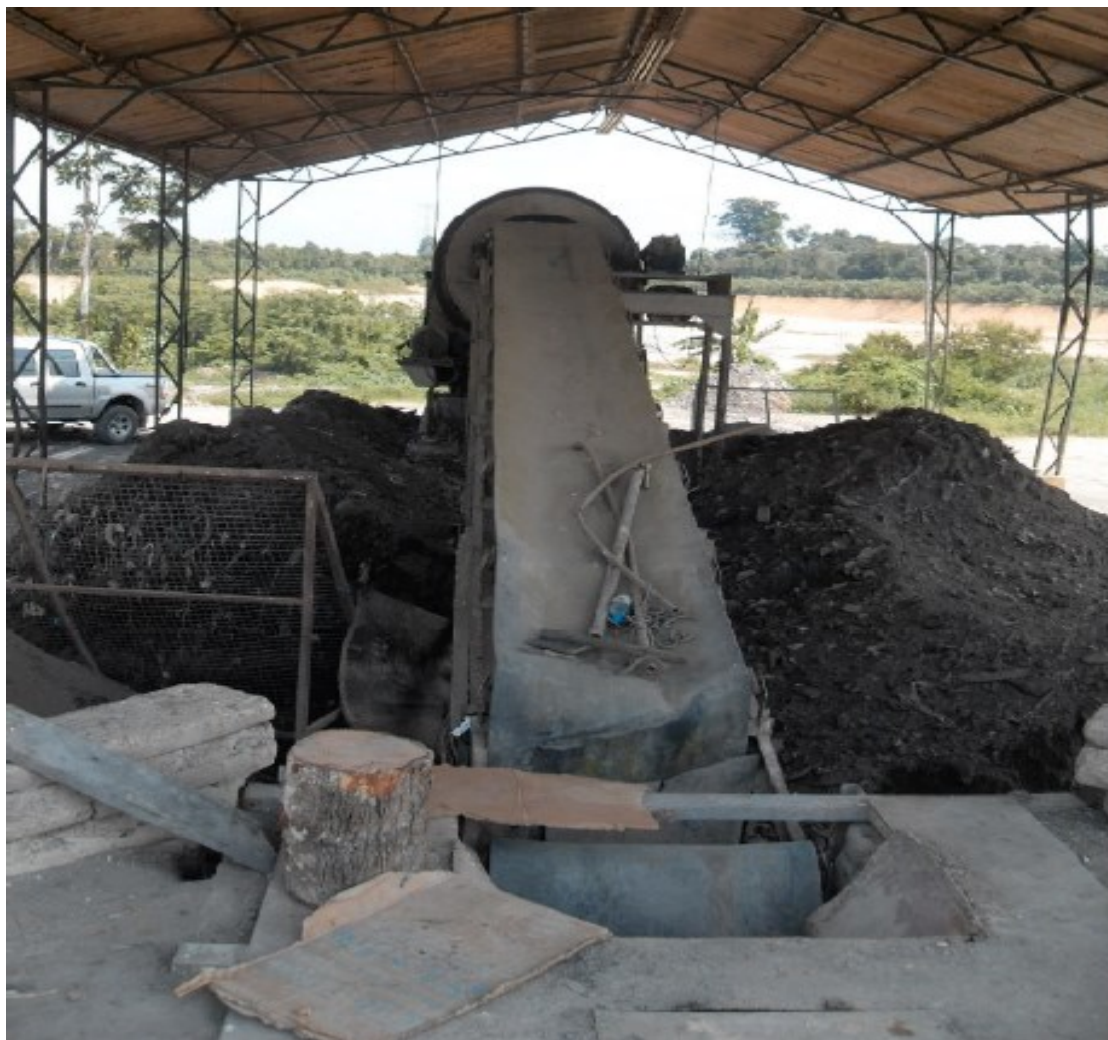
Fig. 7: Equipamento quebrado. Utilização de peneira manual para a realização dos serviços. Fonte: Relatório de Auditoria Operacional realizada no Programa de Governo “Manaus mais Limpa”, na área de Resíduos Sólidos Urbanos – RSU 2010.
