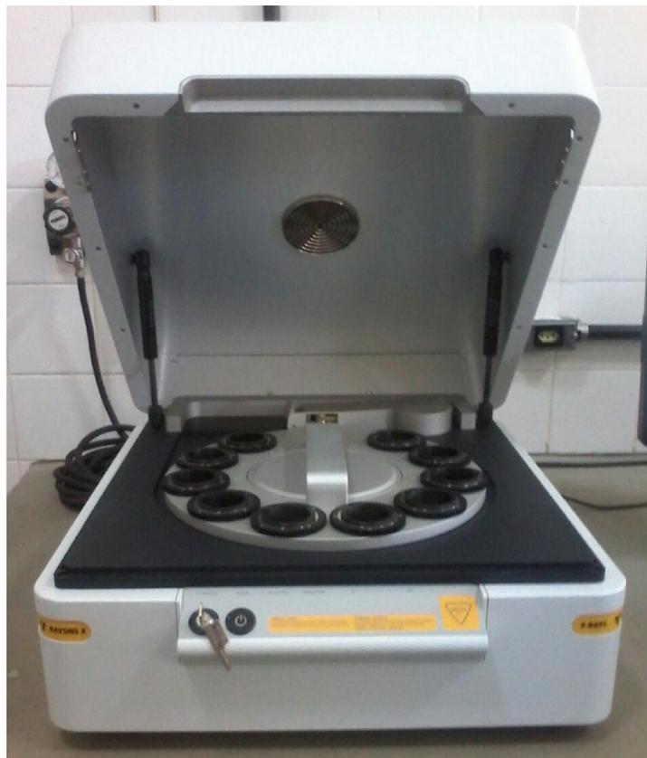
**Figura 15:** Espectrômetro de Fluorescência de Raios X PANalytical (Modelo Epsilon XL).
