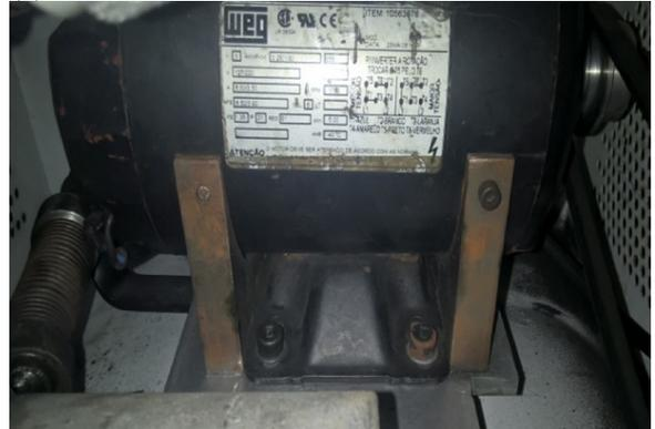
**Figura 12:** Moinho vibratório para realização do processo de moagem mecânica de alta energia (Tipo SPEX). Equipamento modificado com base fixada no motor (a) e (b).
