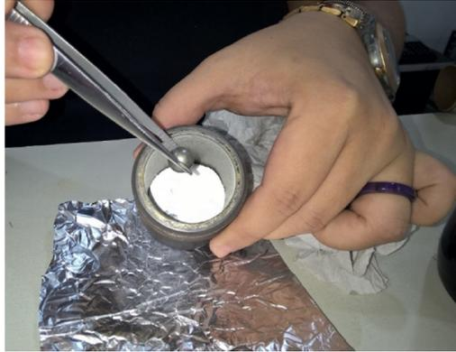
**Figura 11:** Colocação da amostra no cilindro, acrescido do ácido esteárico e esferas (previamente pesados).
