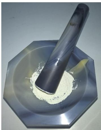
**Figura 9:** Maceração da amostra de Zn antes da mesma ser colocada no cilindro.
