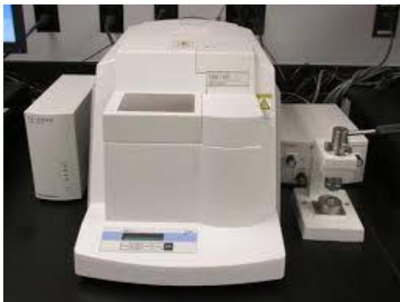
**Figura 11.** Visão panorâmica do equipamento utilizado DSC-60 da Schimadzu [Laboratório de Síntese e Caracterização de Materiais (LSCN) do Instituto Federal do Amazonas (IFAM)].
