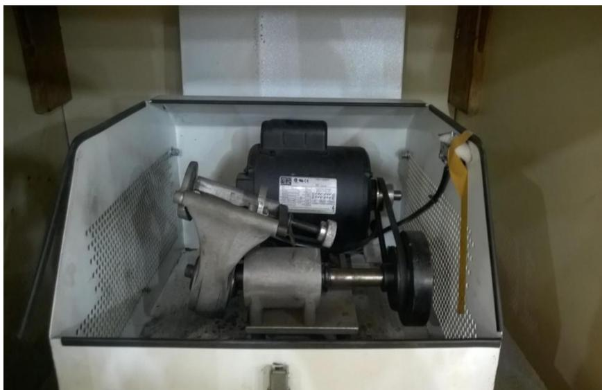
**Figura 3.** Moinho vibratório para realização do processo de moagem mecânica de alta energia [Laboratório de Materiais (LabMat) do Departamento de Física da UFAM].
