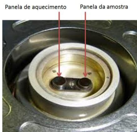
**Figura 8.** Célula do DSC do tipo disco [Laboratório de Síntese e Caracterização de Materiais (LSCN) do Instituto Federal do Amazonas (IFAM)].
