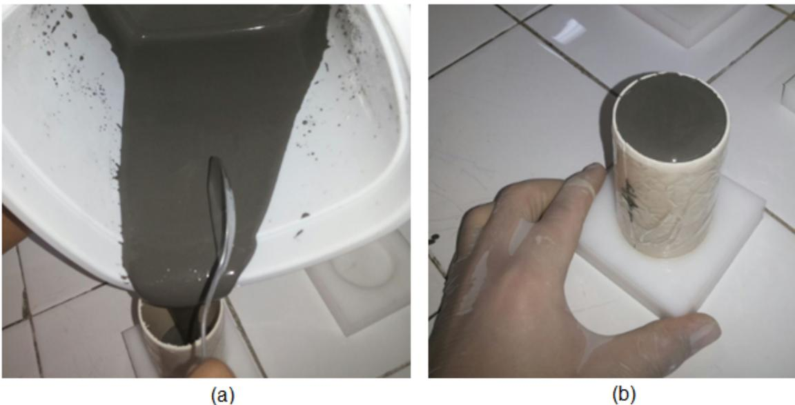
Figura 36: *Moldagem dos corpos de prova*
