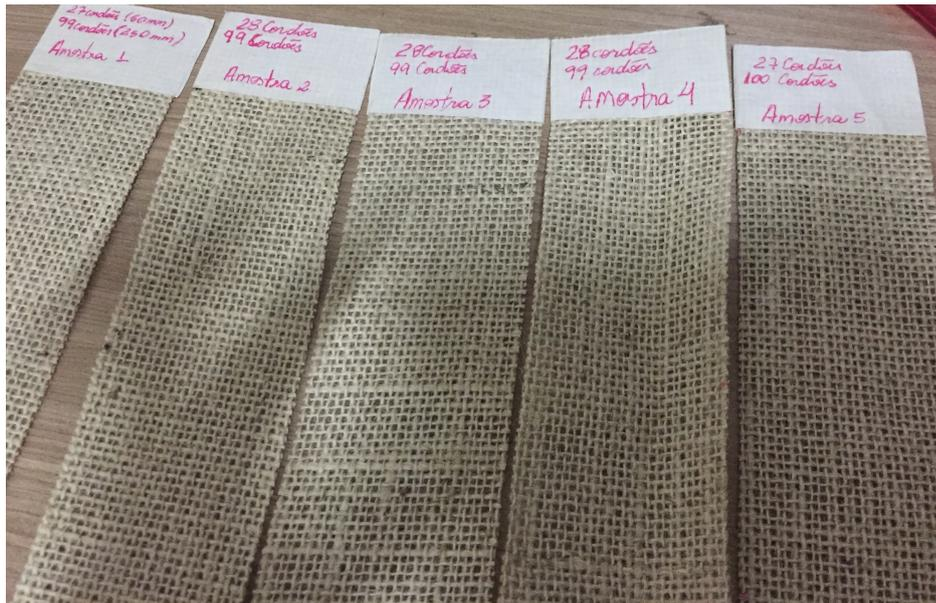
Figura 30: Preparação das amostras de tecido para ensaio de tração
