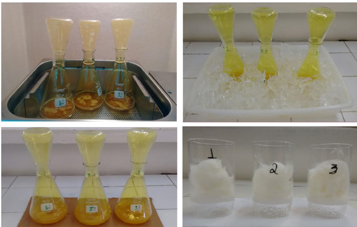
Figura 35: *Ensaio de holocelulose do tecido de juta*
