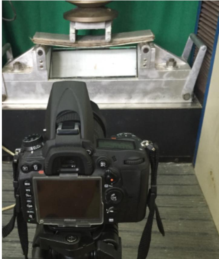
Figura 44: *Set-up para análise da fissuração durante os ensaios de Flexão*
