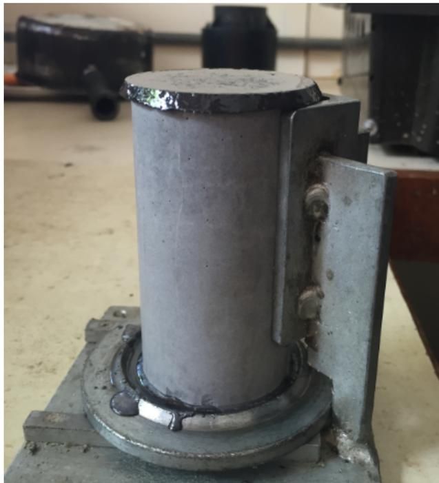
Figura 40: *Faceamento do corpo de prova*
