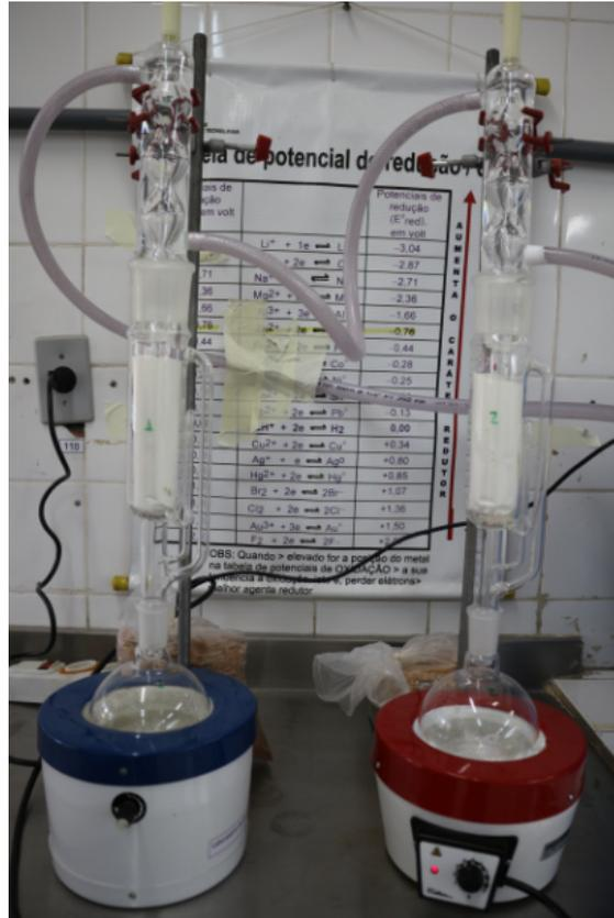
Figura 34: Esquema do ensaio de teor de extrativos
