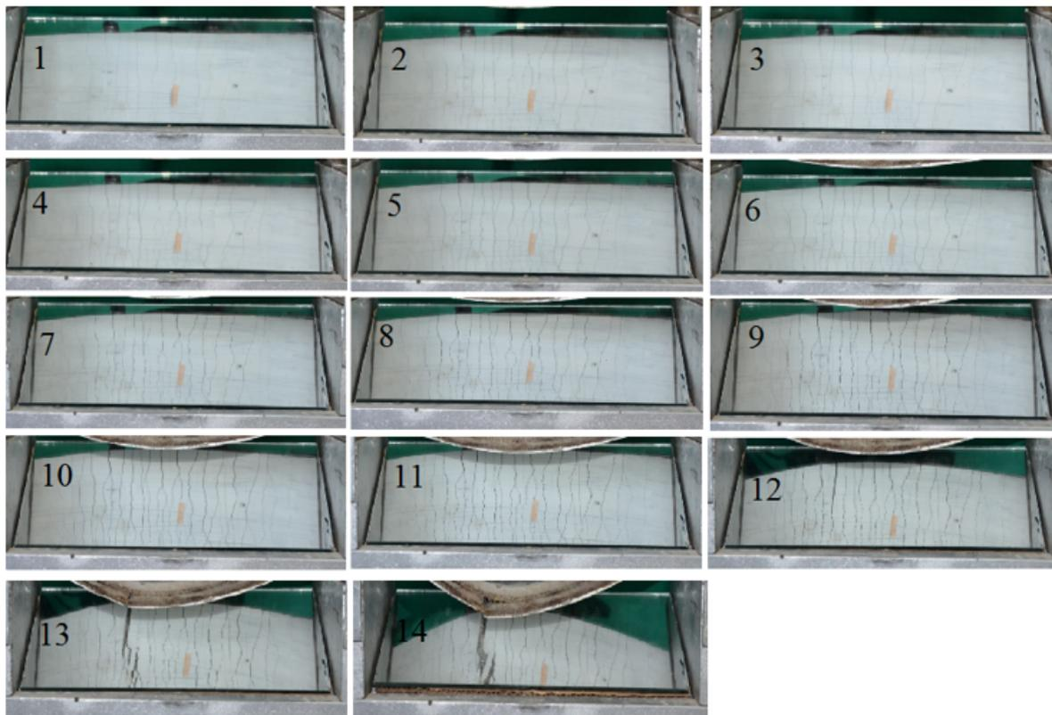
Figura 49: Padrão de fissuração típico dos compósitos pré-fissurados, observados durante os ensaios.
