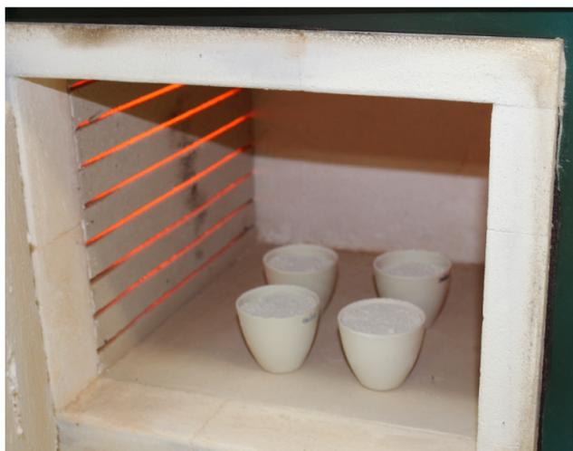
Figura 18: Forno mufla utilizado para calcinação da metacaulinita
