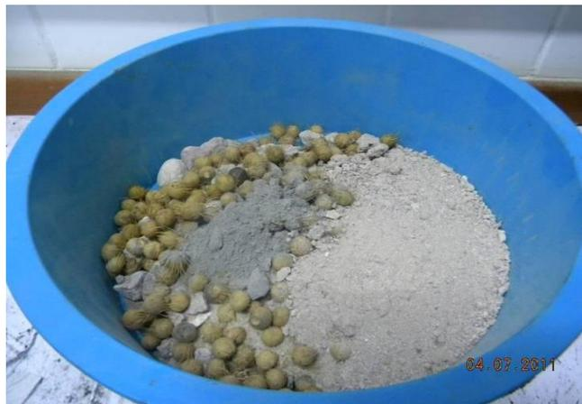
Figura 61 – Material da mistura, 50% de caroço de açaí.
