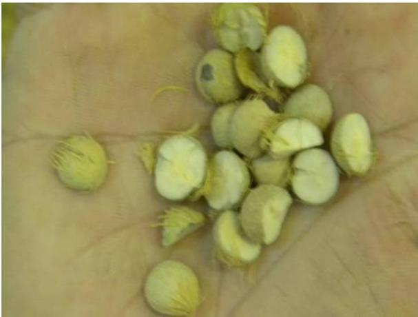
Figura 45 – Caroço após o ensaio de Abrasão *Los Angeles*.
