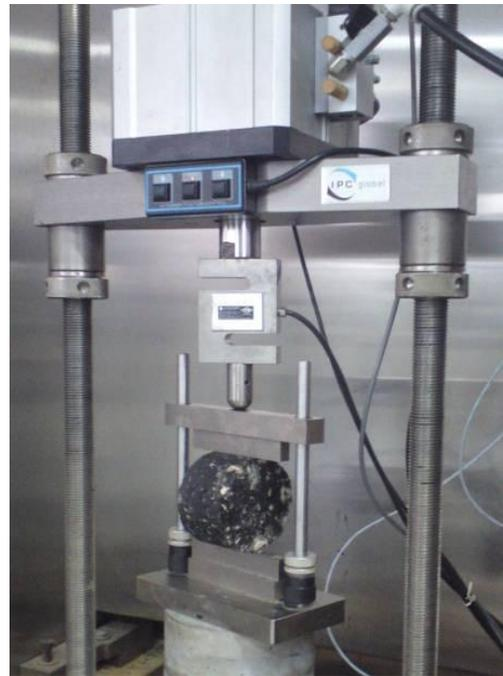
Figura 36. Ensaio de Resistência à Tração (UTM-14).
