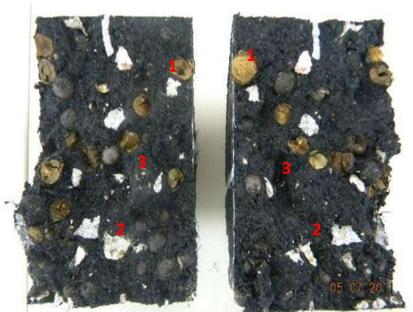
Figura 63 – Aspecto do CP da mistura 2 após o ensaio de RT.
