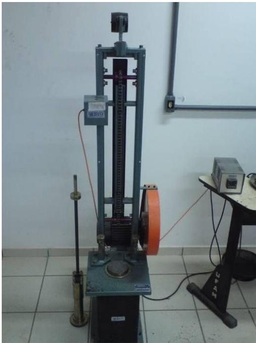
Figura 35. Compactador mecânico Marshall.
