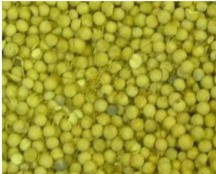
Figura 42 – Carço do açai após o tratamento, 5 a 12mm.
