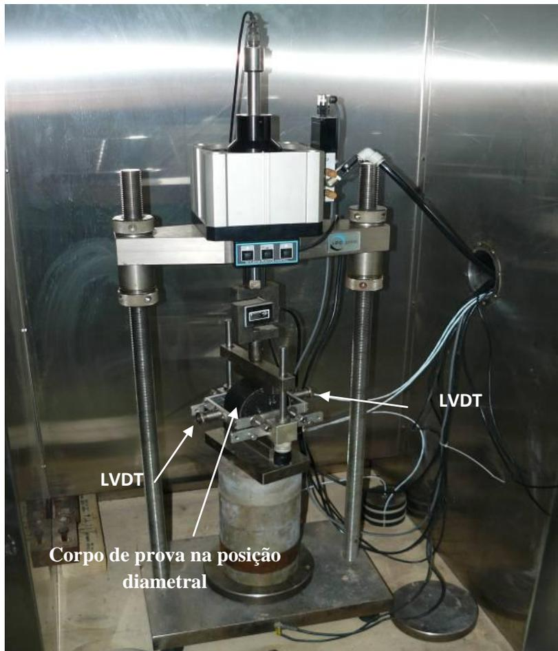
Figura 40. Ensaio do Módulo de Resiliência (UTM), (Cavalcante *et al*, 2010).
