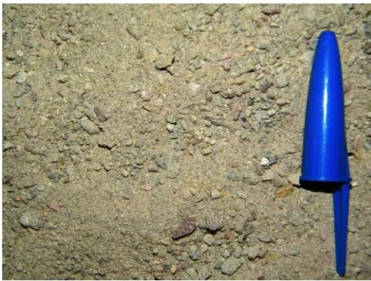
Figura 34 – Areia de RCD (Oliveira *et al*, 2010).
