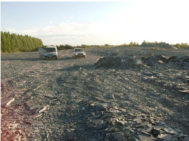
Figura 19 – Aspecto de Um Aterro para Disposição dos Resíduos de Exploração e Beneficiamento da Ardósia em Papagaios/MG. Fonte: Rodrigues (2011).
