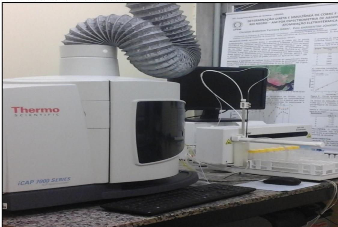
A escolha das linhas de emissão foi feita com base em experiências anteriores na determinação destes metais, foram selecionados os comprimentos de onda que evitassem interferentes e tivessem a sensibilidade necessária para cada elemento determinado. A Tabela 5 descreve as condições operacionais que foram selecionadas para determinar a concentração dos metais no sedimento.
