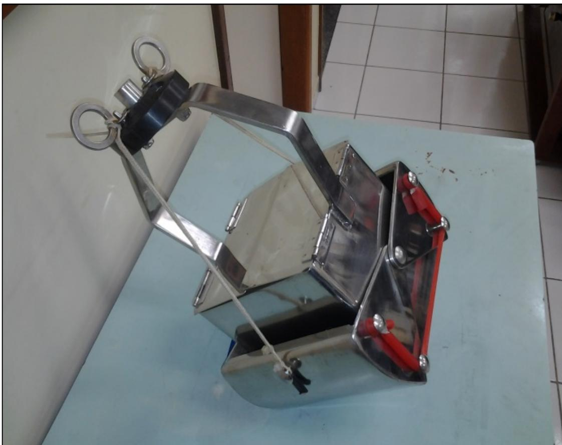
A coleta consistiu no lançamento da draga Birge-Eckman até o fundo do reservatório (Figura 3.a) e em seguida a amostra foi recolhida e o material coletado foi depositado em uma bandeja de Polietileno (Figura 3.b) forrada com saco plástico. O sedimento coletado foi homogeneizado, transferido para sacos de feixe hermético e mantido resfriado até a preparação da amostra no Laboratório de Química Analítica Ambiental (LQAA) no Instituto Nacional de Pesquisa do Amazonas (INPA).
