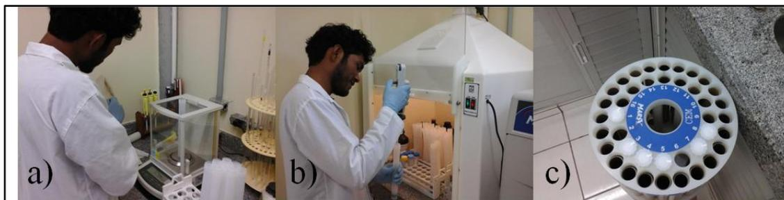
**Legenda:** a) Pesagem da massa de sedimento usada para extração; b) Adição do  $\text{HNO}_3$  concentrado; c) Carrossel onde os tubos de teflon do forno micro-ondas são organizados e levados ao equipamento para o início da extração.
