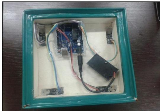
Figura 37 Peça quadrada com sensores hall e Arduino.
