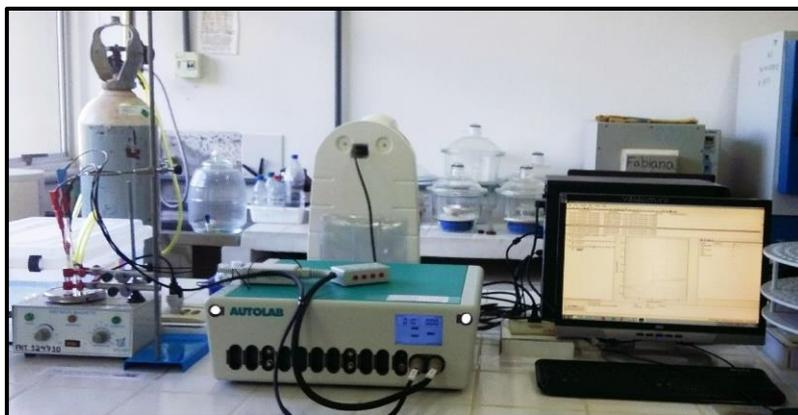
**Figura 7:** Potenciostato acoplado ao computador com software Nova 1.10.
