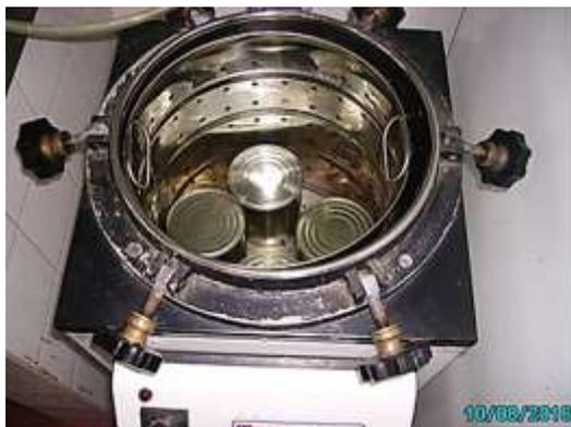
**Figura 16.** Esterilização das latas em autoclave vertical, após recravação.
