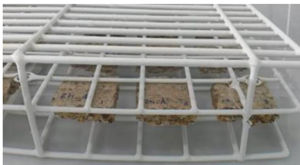
Figura 17 - Imersão dos corpos de prova em água destilada, para ensaio de inchamento
