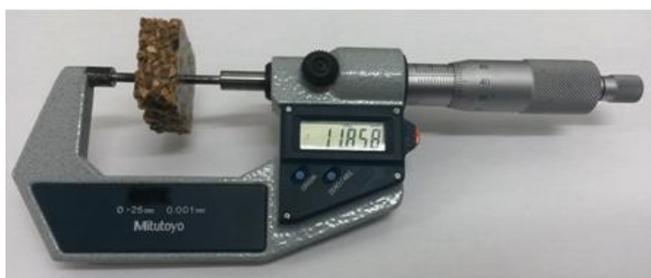
Figura 16 - Medição dos corpos de prova com micrômetro, para ensaio de inchamento
