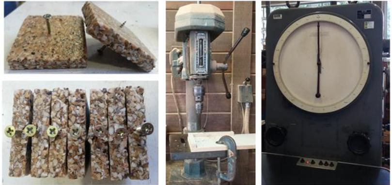
Figura 21 - Equipamentos e corpos de prova do ensaio de arrancamento de parafuso
