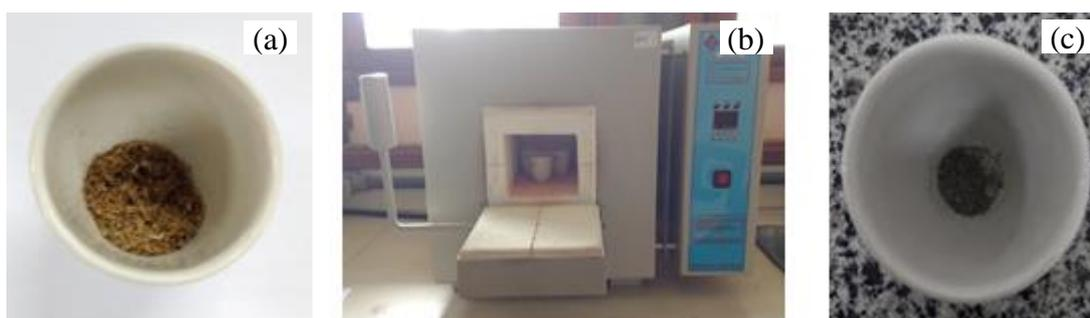
Figura 12 - Etapas do ensaio de teor de cinzas: a) 1 g de partícula de amostra de resíduo de açai; b) Amostra no forno Mufla; c) Cinzas
