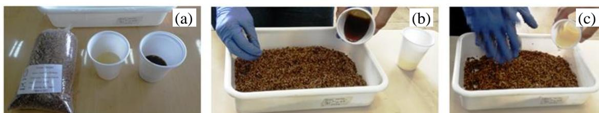
Figura 14 – Etapa inicial da produção de painéis particulados: a) Separação da resina e das partículas; b) Mistura do pré-polímero com as partículas de caroço de açaí; c) Mistura do polioli com as partículas de caroço de açaí
