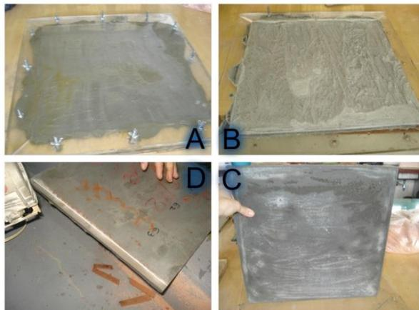
Figura 12 - Desforma das placas, onde (A) placa após 24 horas de moldagem, (B) retirando as placas da forma e (C) e (D) placas após a desforma.
