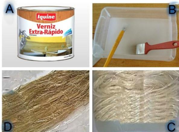
Figura 8 - Impermeabilização das fibras, onde (A) verniz utilizado, (B) recipiente para imersão, (C) fibras imersas e (D) fibras tratadas secas.
