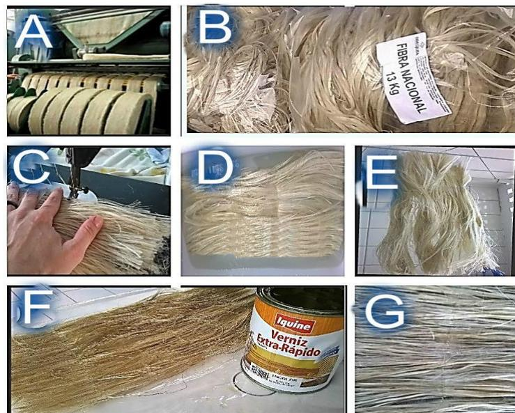
Figura 4 - Processo de preparação das fibras, compreendendo (A) e (B) coletadas na fábrica, (C) costura das fibras, (D) e (E) processo de hornificação, (F) imersão das fibras com verniz e (G) Fibras naturais sem tratamento.
