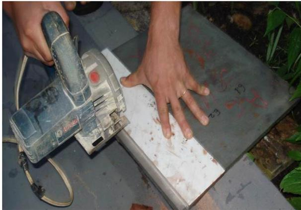
Figura 13 - Corte das placas para preparação de amostras para ensaios.
