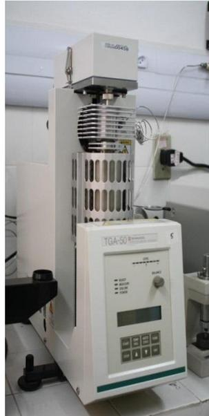
Figura 14 - Equipamento utilizado no ensaio termogravimétrico.
