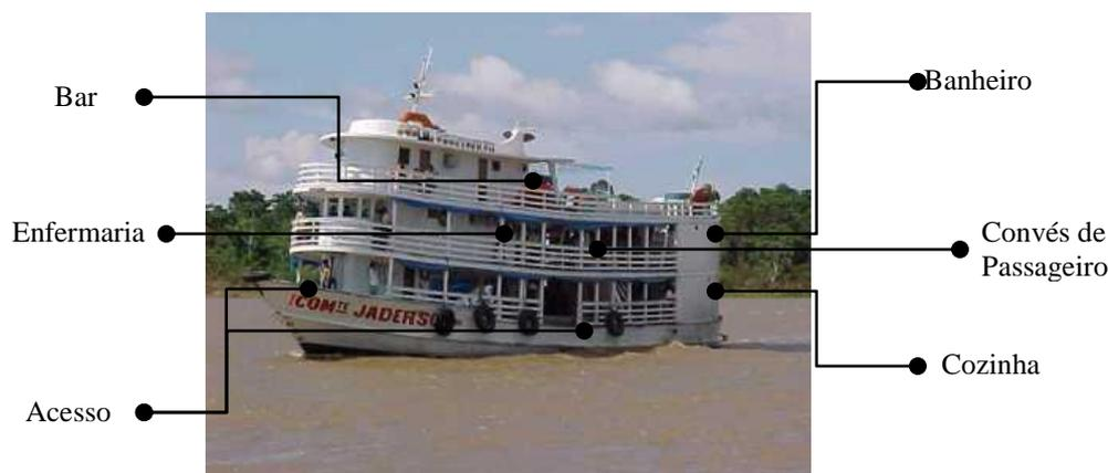
Figura 9 - Conjunto de critério a serem usados para classificação das embarcações.
